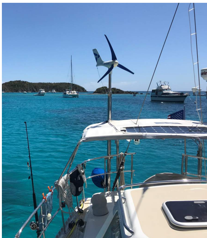
Slika 7. Montirana brodska vjetroturbina
