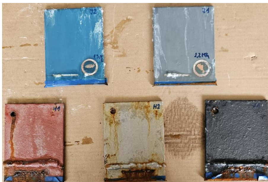
Slika 72. Izgled uzoraka nakon 1440 sati u slanoj komori
