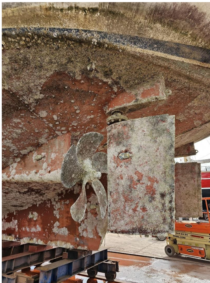
Slika 12. Obraštanje broda u području propelera
