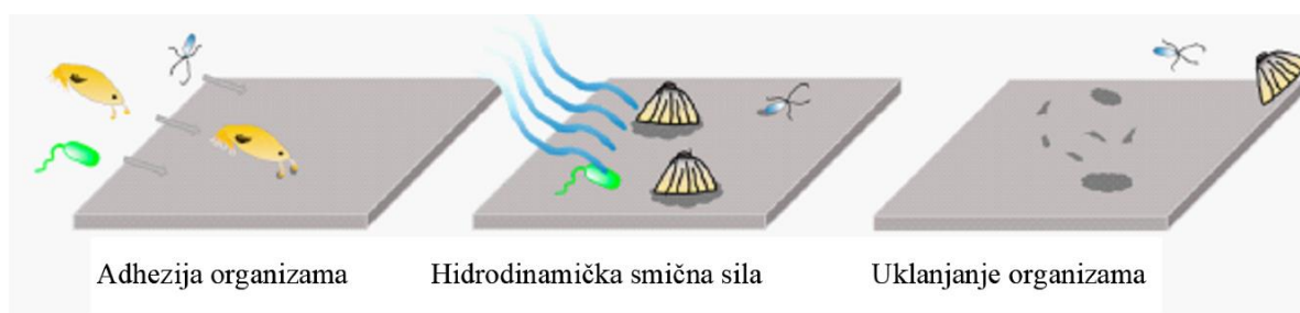
Slika 27. Princip funkcioniranja FR premaza [30]
