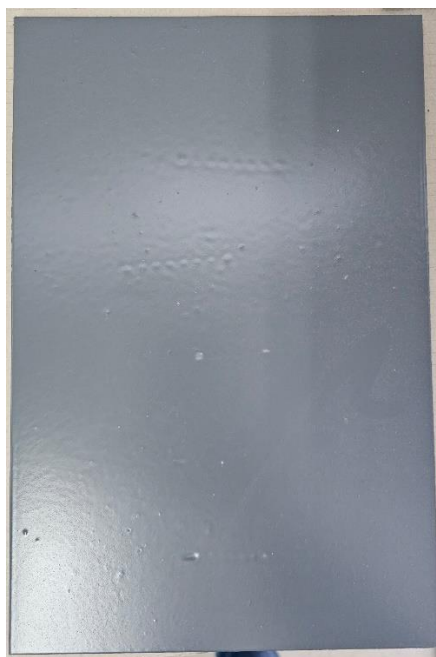
Slika 45. Uzorak J1 nakon nanošenja kompletnog sustava premaza
