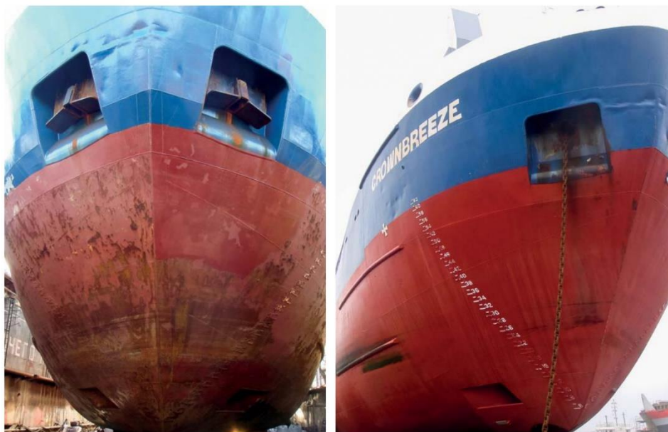
Slika 36. Trup broda za prijevoz općeg tereta koji plove u Baltičkom moru: stanje trupa zaštićenog konvencionalnim AF premazom nakon 1 godine eksploatacije (slika lijevo), stanje trupa zaštićenog Ecospeed ® premazom nakon 2,5 godine eksploatacije (slika desno)
