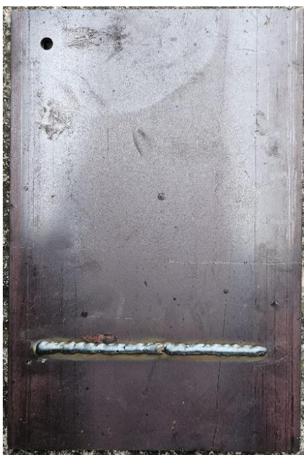
Slika 54. Uzorak N zaštićen shopprimerom
