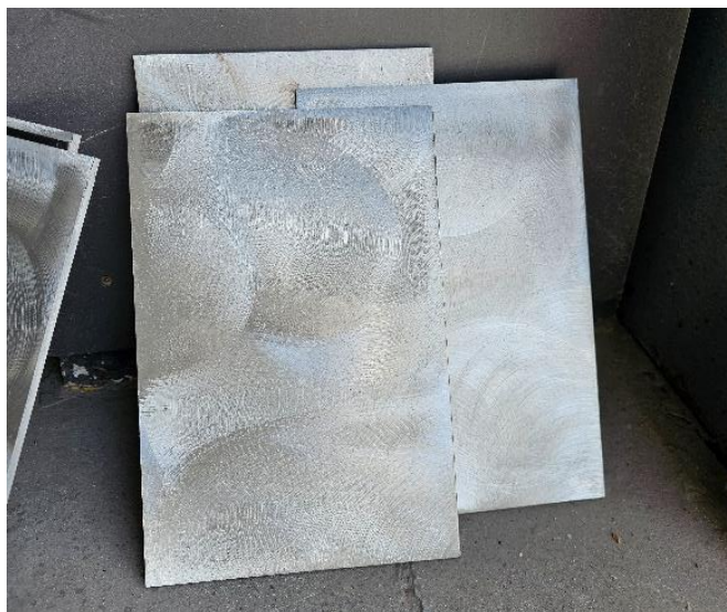
Slika 40. Uzorci pripremljeni za nanošenje premaza
