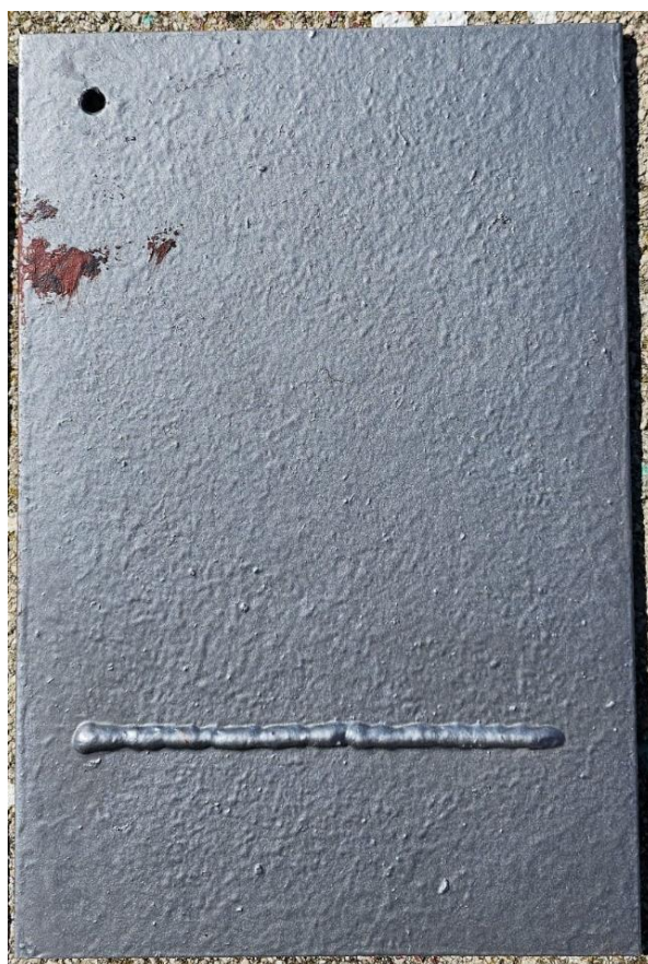
Slika 51. Uzorak H2 nakon nanošenja kompletnog sustava premaza
