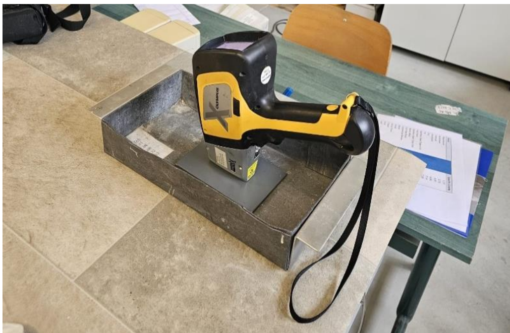
Slika 57. Uređaj korišten za XRF analizu kemijskog sastava premaza
