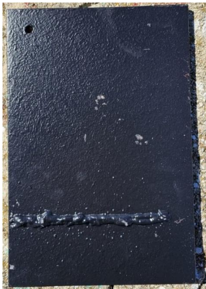
Slika 53. Uzorak I1 nakon nanošenja kompletnog sustava premaza
