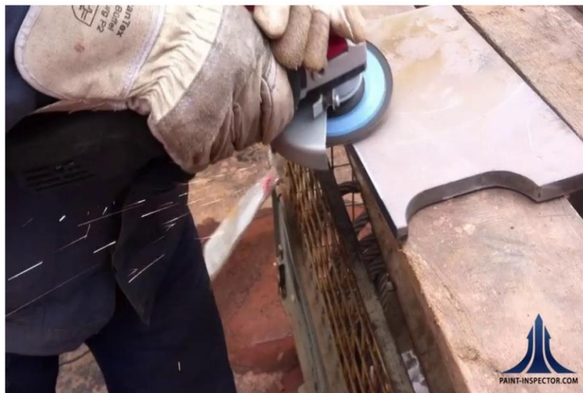
Slika 11. Primjer obrade rubova profila brusilicom [7]
