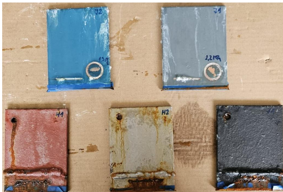
Slika 72. Izgled uzoraka nakon 1440 sati u slanoj komori
