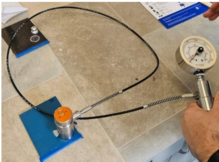
Slika 66. Postupak apliciranja sile hidrauličkim uređajem i mjerenje adhezije
