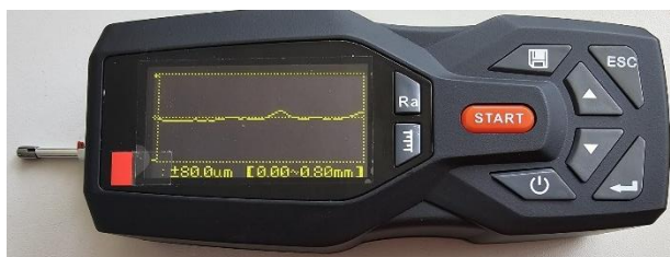
Slika 67. Uređaj za određivanje hrapavosti površine
