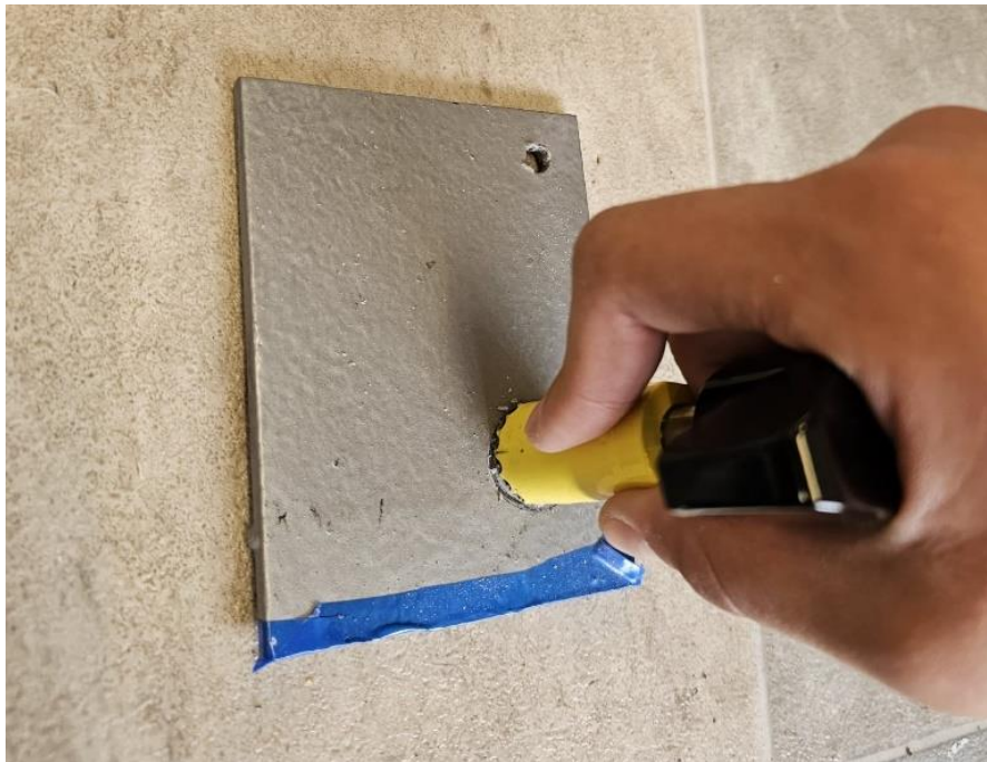
Slika 65. Priprema kružnog reza oko čunjića
