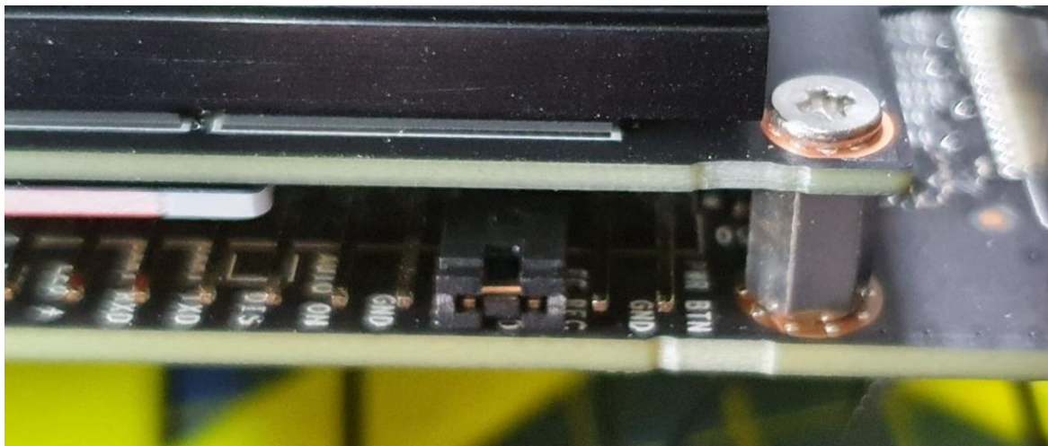
Slika 5. Spajanje pinova za pokretanje Jetson Xavier NX računala u recovery mode načinu rada
