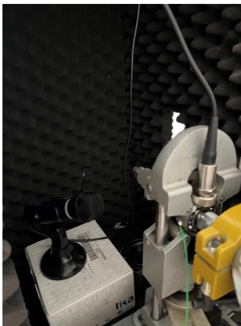
Slika 24. Mikrofon za ispitivanje buke ležaja i senzor vibracija ležaja
