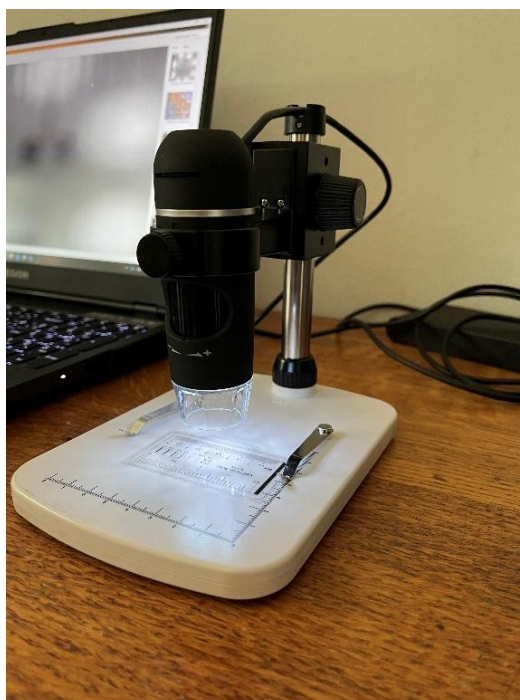
Slika 30. Analiza površine uzoraka primjenom svjetlosnog mikroskopa s kamerom
