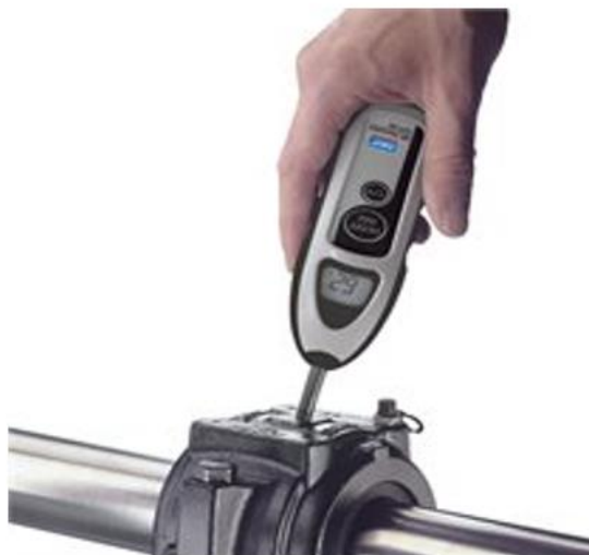
Slika 17. Mjerenje temperature ležajeva pomoću kontaktnog termometra [10]
