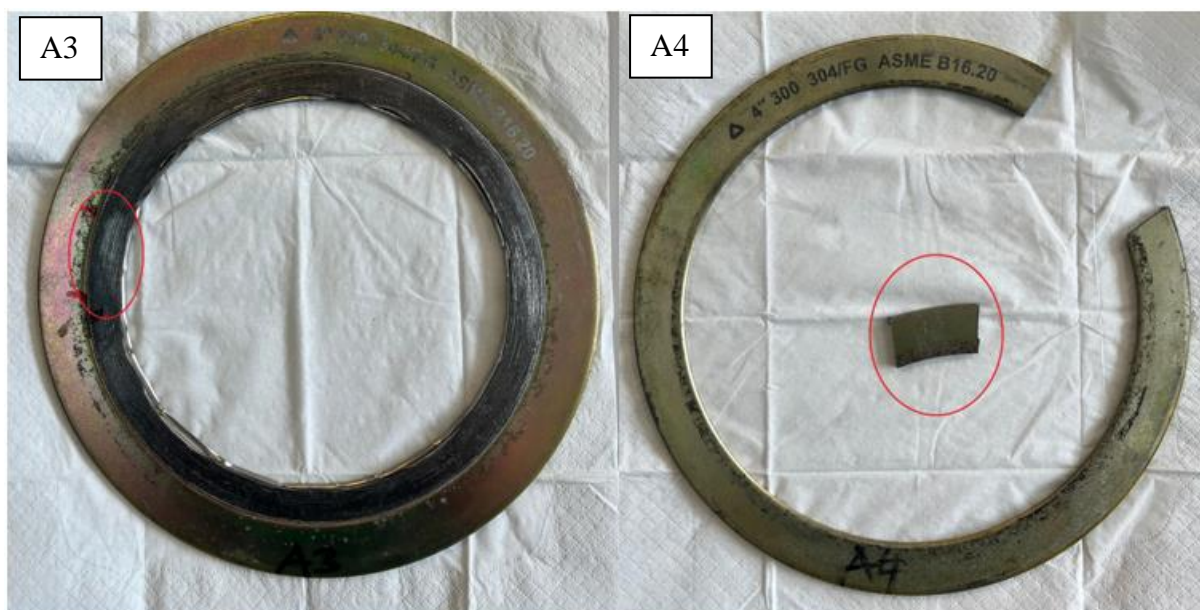
Slika 47. Pripremljeni uzorci za elektrokemijska ispitivanja istosmjernom strujom
