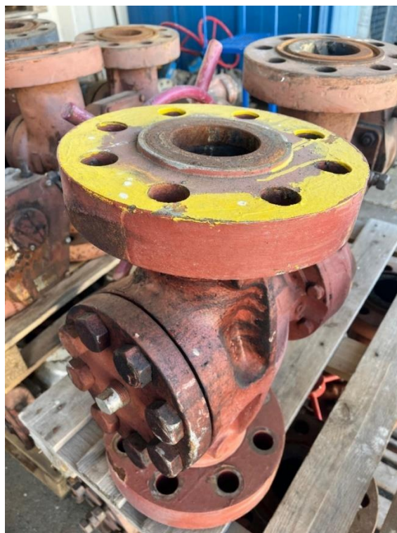
Slika 23. Ventili plinovoda pripremljeni za servis
