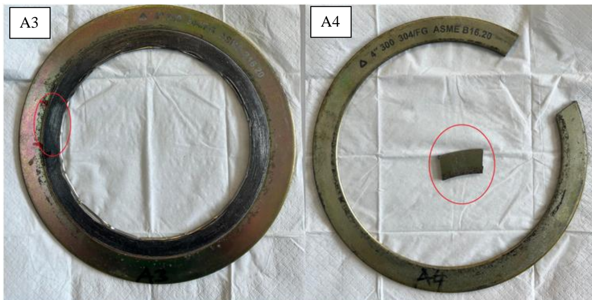
Slika 47. Pripremljeni uzorci za elektrokemijska ispitivanja istosmjernom strujom
