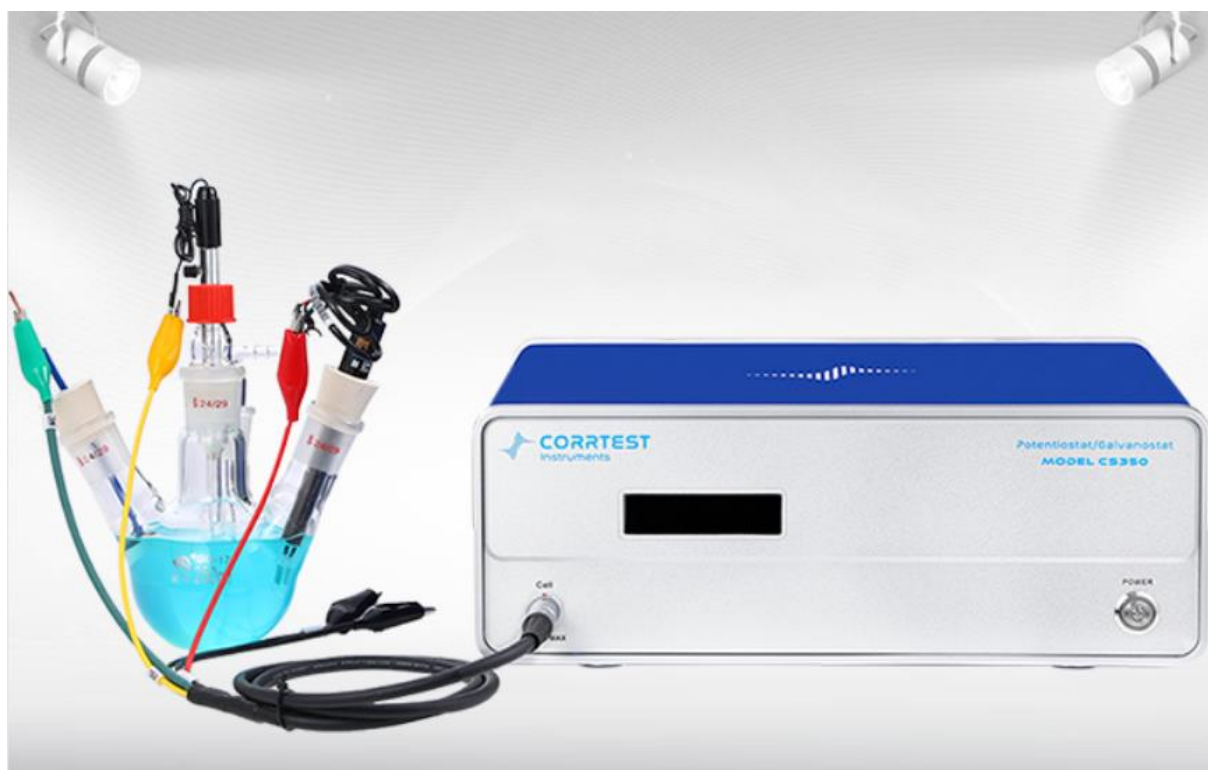
Slika 19: Potenciostat i elektrokemijska ćelija [23]
