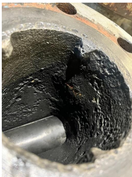
Slika 25. Kavitacijska oštećenja na ventilu
