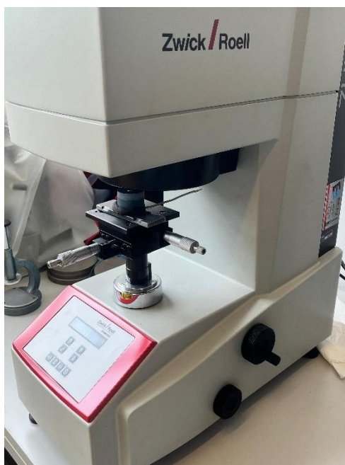
Slika 40. Tvrdomjer ZHV \mu -S Micro Vickers
