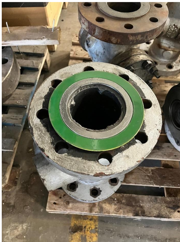
Slika 24. Ventil sa spiralno-metalnom brtvom
