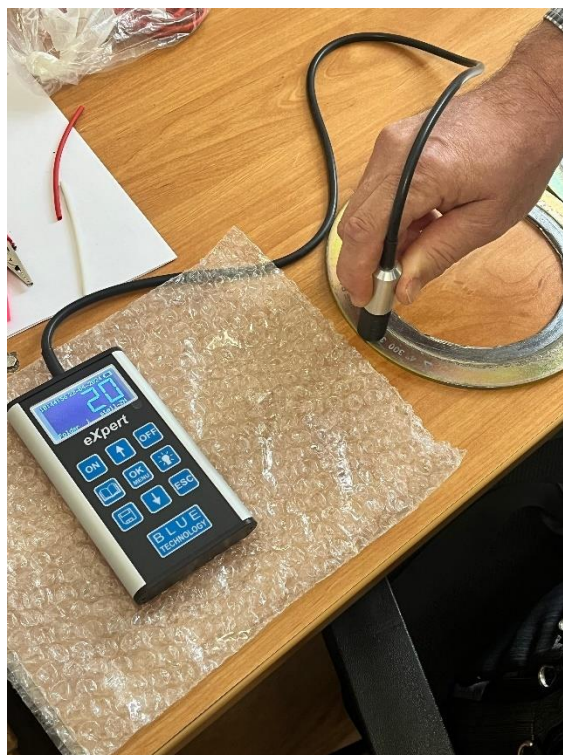
Slika 27. Mjerenje debljine prevlake brtve A3
