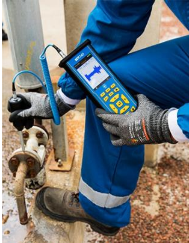
Slika 11. Ultrazvučna inspekcija parne zamke [10]
