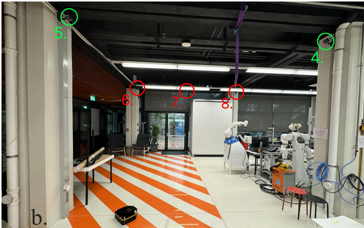
Slika 5.2: a. Prvi skup kamera vizijskog sustava OptiTrack b. Drugi skup kamera vizijskog sustava OptiTrack
