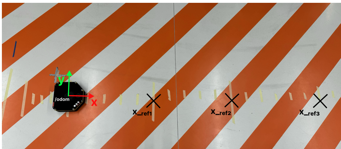
Slika 5.7: Prikaz robota u početnoj poziciji s označenim referentnim pozicijama i ishodištem
