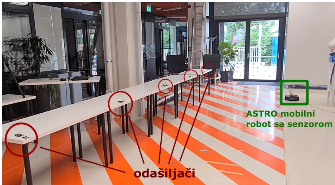
Slika 59. Test detekcije i identifikacije odašiljača
