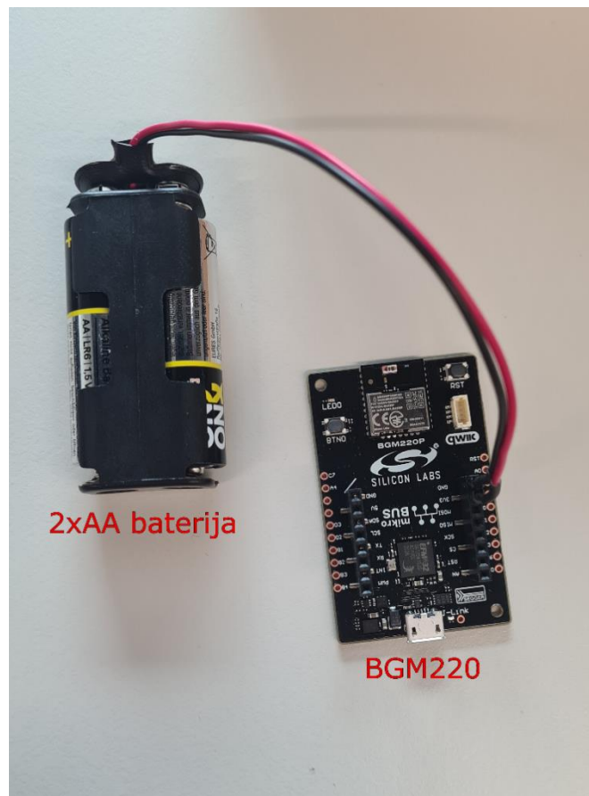
Slika 48. BGM220 napajan pomoću 2x AA baterije
