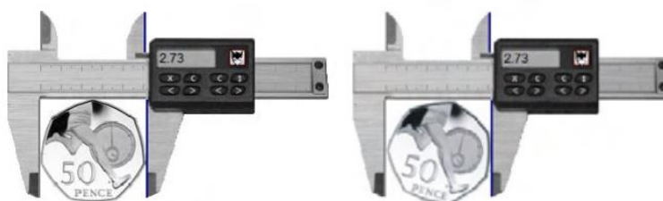
Slika 5. Mjerenje promjera na različitim mjestima [4]
