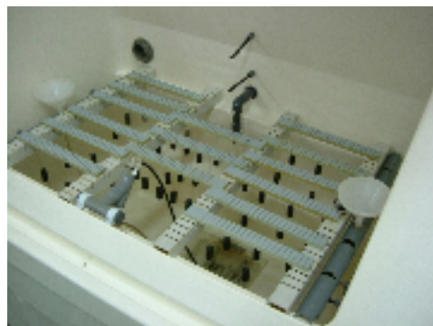
Slika 25. Uzorci od čelika Ck45 postavljeni u slanu komoru " Ascott " .
