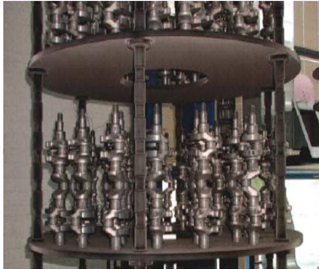
**Slika 7.** Koljenasta vratila obrađena postupkom PLASOX [10].
