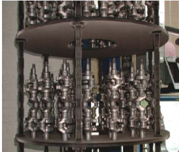
Slika 7. Koljenasta vratila obrađena postupkom PLASOX [10].
