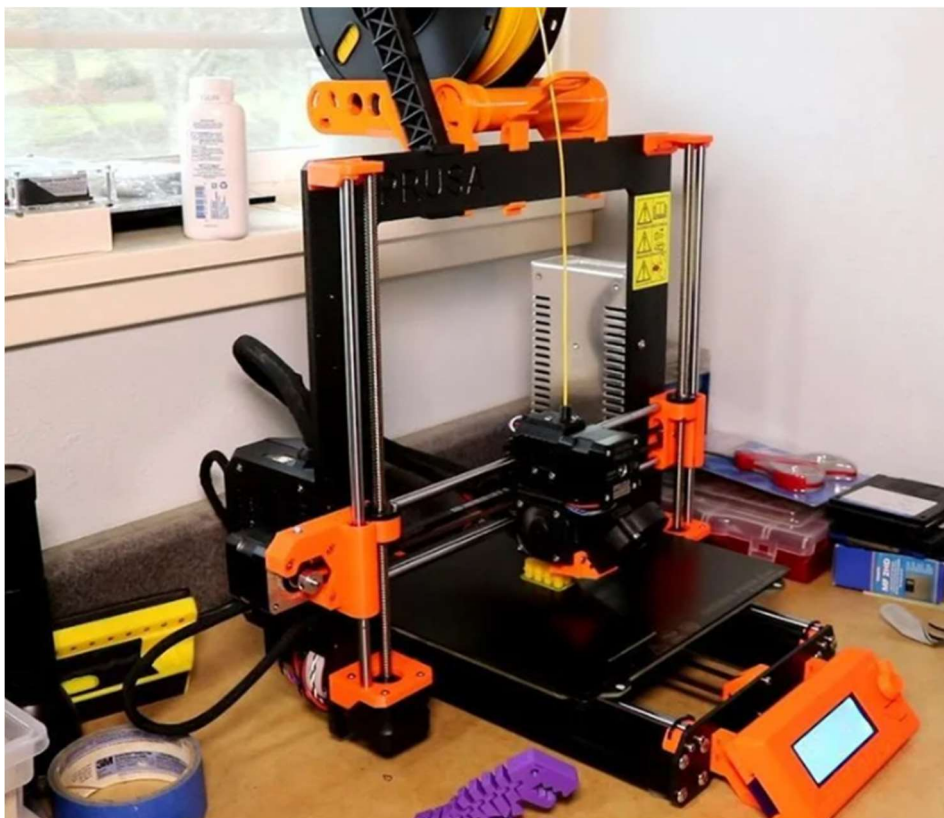
Slika 8. Kartezijski FDM 3D pisac [8]
