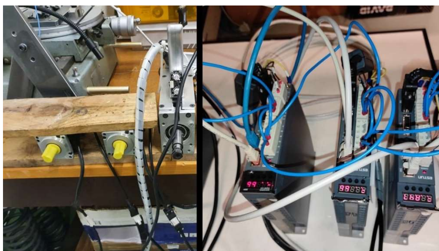
Slika 19. Ispitni postav za Delta 3D pišač
