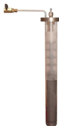
Slika 7: Ćelija za postizanje fiksne točke aluminija
