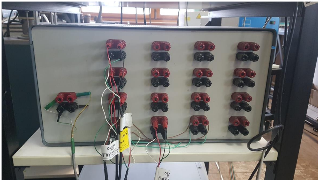
Slika 19: Multipleksor sa spojenim termometrima
