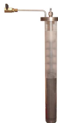
Slika 7: Ćelija za postizanje fiksne točke aluminija
