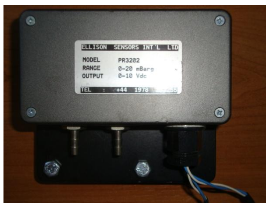
Slika 5.3 Električni manometar korišten u radu
