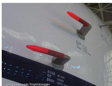
Slika 2.5 Pitot cijevi, modernog transportnog zrakoplova [22]
