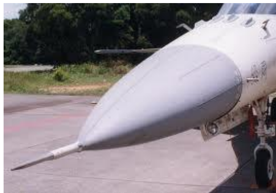
Slika 6.2 Pitot cijevi zrakoplova F-16 [21]
