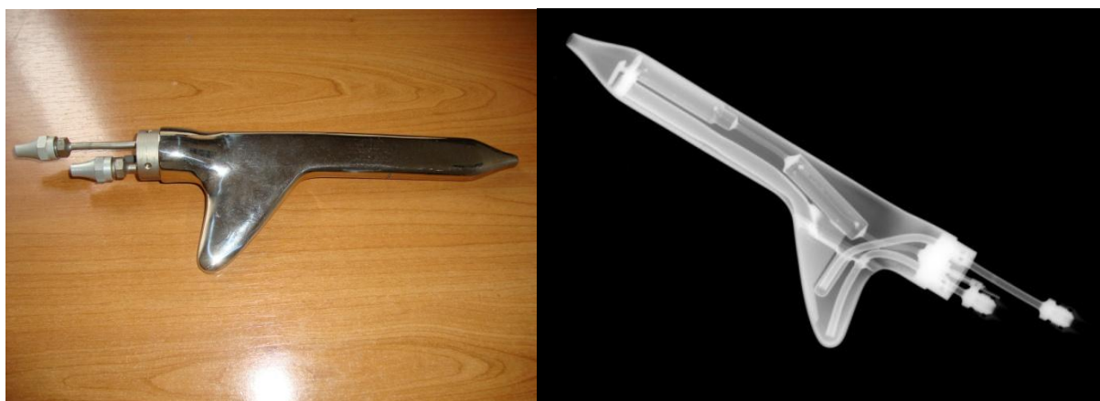
Slika 3.1 a) Kollsmanova cijev pomoću koje je izvršeno mjerenje b) Radiografski prikaz Kollsmanove cijevi
