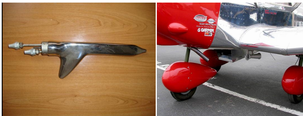
Slika 1.1 a) Kollsmanova Pitot cijev b) Primjer sonde vakuumskog sustava mjerenja brzine, na lakome zrakoplovu [23]
