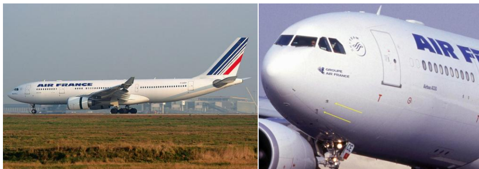
Slika 2.4 a) Zrakoplov registracijske oznake F-GZCP, izgubljen u nesreći na letu 447 [12] b) Isti zrakoplov, s označenim Pitot cijevima (žute strjelice)[12]
