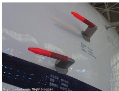
Slika 2.5 Pitot cijevi, modernog transportnog zrakoplova [22]
