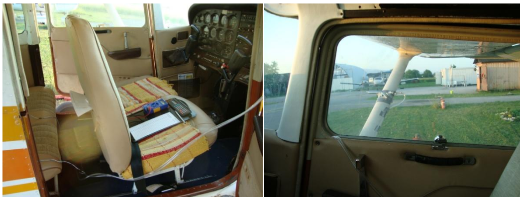
Slika 7.7a) Oprema postavljena u zrakoplov b) Pogled na Pitot cijev iz pilotskog sjedišta
