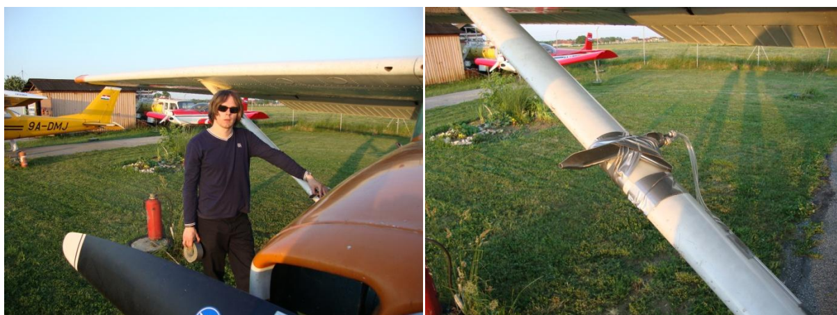
Slika 7.1 a) Montaža Pitot cijevi na desnu upornicu b) Montirana Pitot cijevi na desnu upornicu
