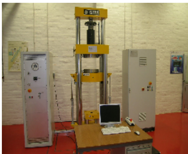
Slika 12: Referentni etalon sile Laboratorija za ispitivanje mehaničkih svojstava (FSB) [6]
