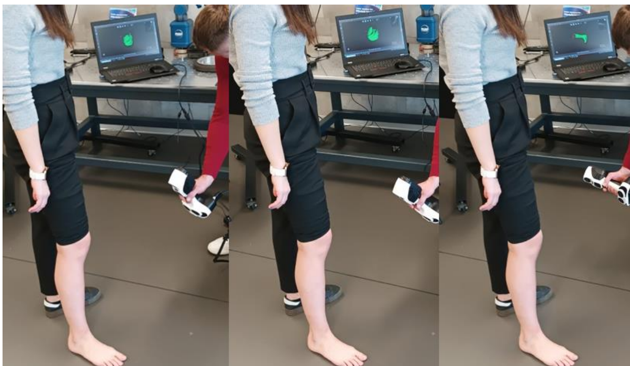
Slika 29. Postupak skeniranja s iReal 2E skenerom
