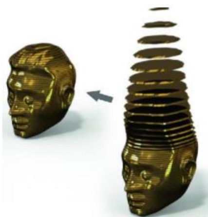
Slika 6. Ispis modela glave sloj po sloj [10]
