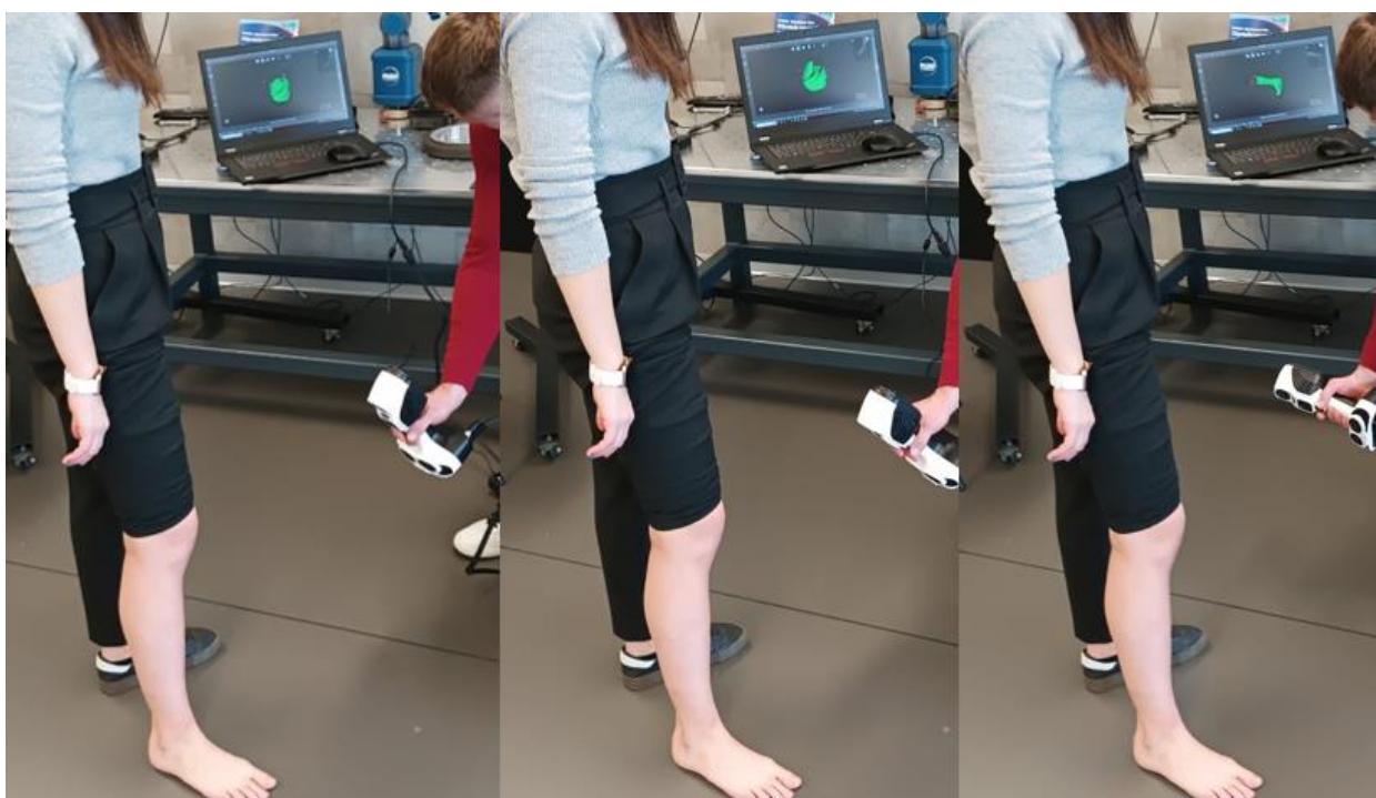
Slika 29. Postupak skeniranja s iReal 2E skenerom
