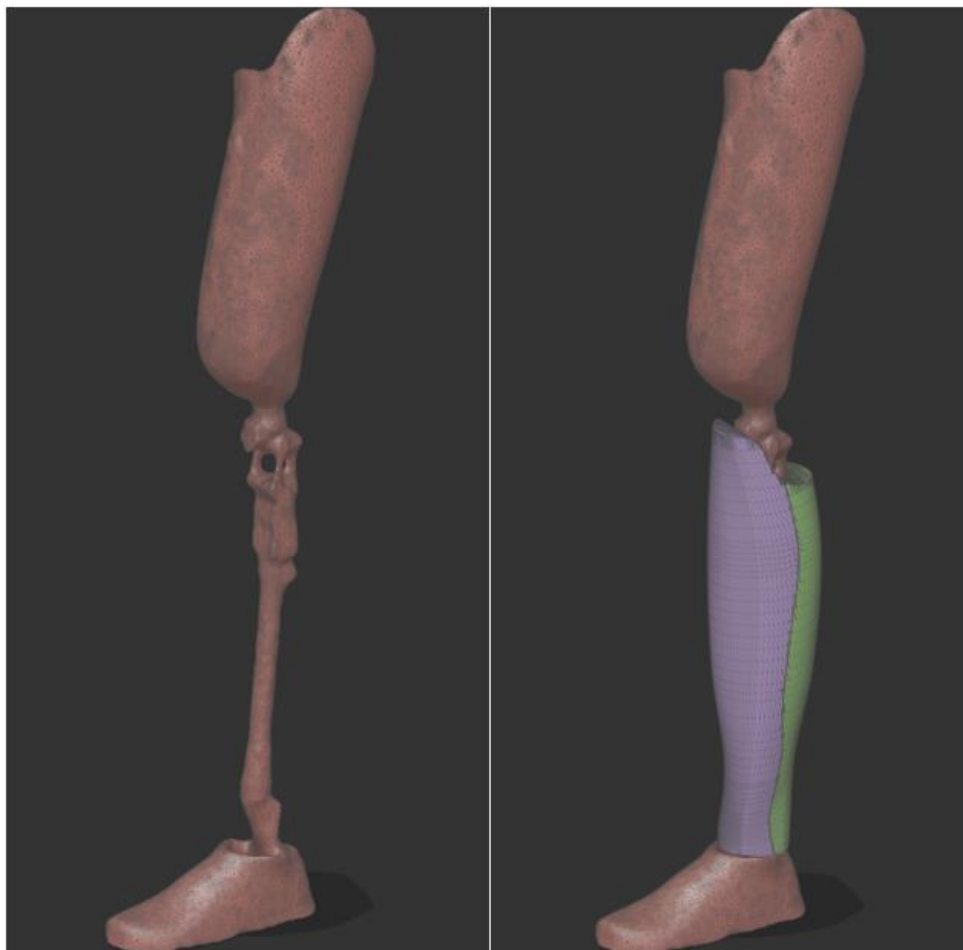
Slika 41. Proteza bez obloge (lijevo) i s oblogom (desno)
