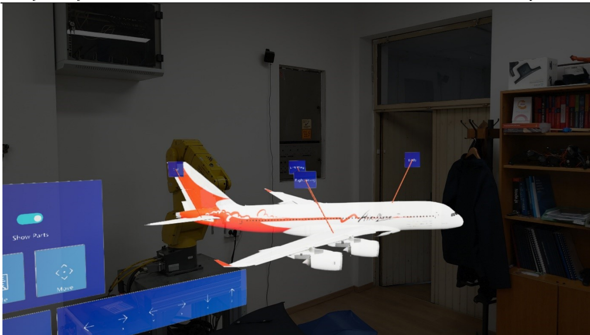
Slika 77. Prikaz virtualnih sučelja koji pokazuju dijelove zrakoplova u sustavu mješovite stvarnosti nakon klika na tipkalo Show Parts
