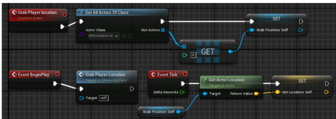
Slika 45. Prikaz Event Graph -a Uxt Pressable Switch Button Actor -a za dohvaćanje i spremanje lokacije korisnika u Unreal Engine-u
