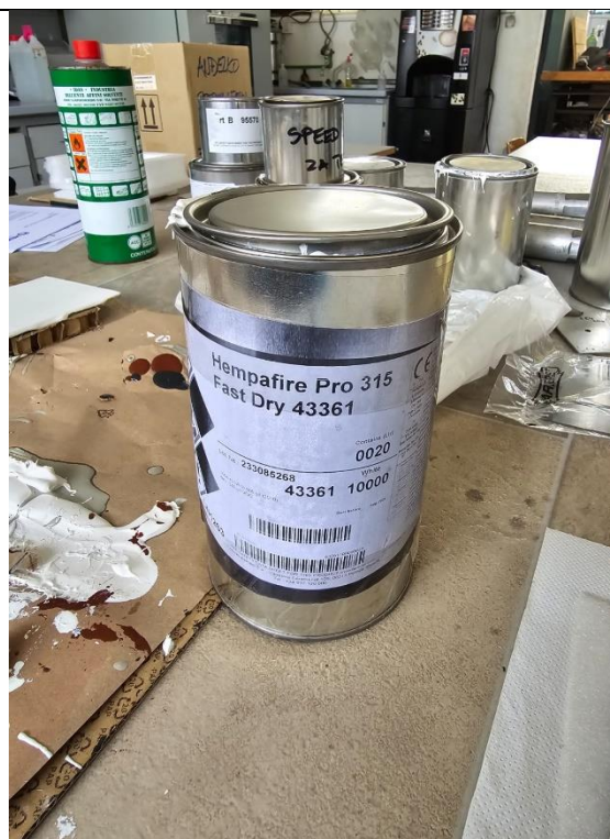
Slika 27 Hempel protupožarni premaz
