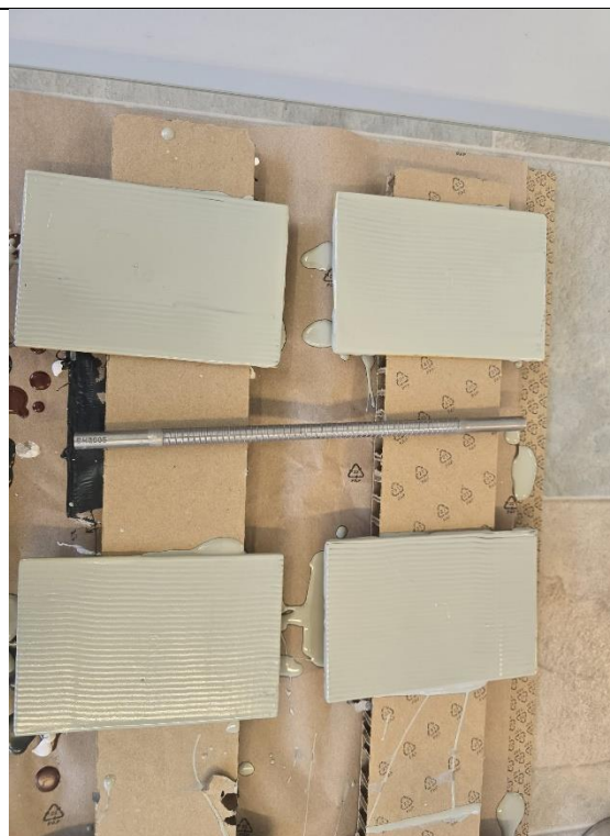
Slika 23 Nanošenje Hempel temeljnog premaza
