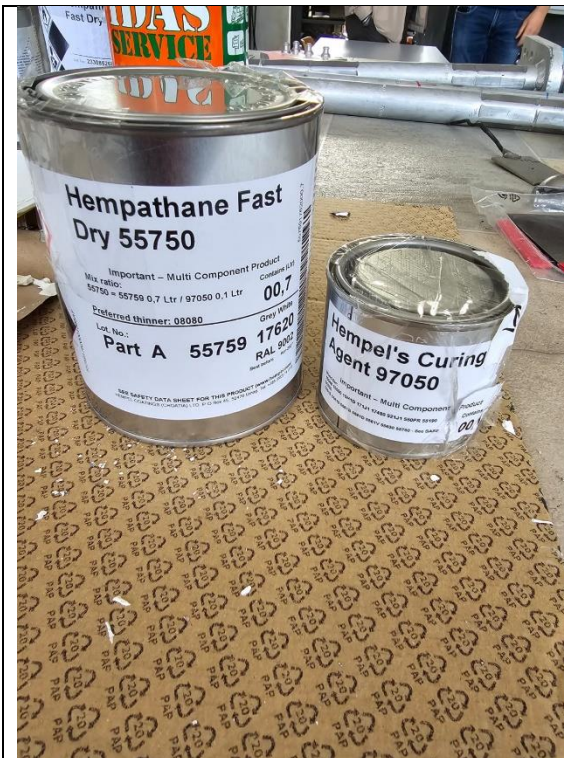
Slika 33 Komponente Hempel završnog premaza
