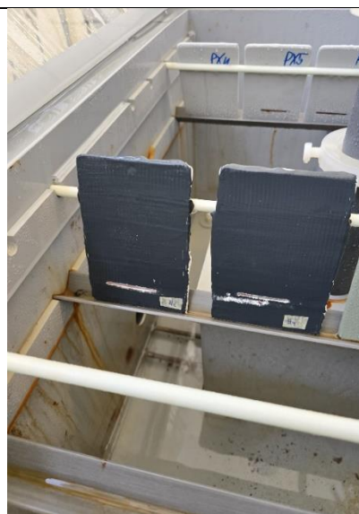
Slika 45 Uzorci u slanoj komori
