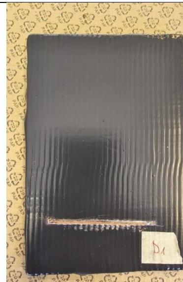
Slika 49 Uzorak D1 prije slane komore
