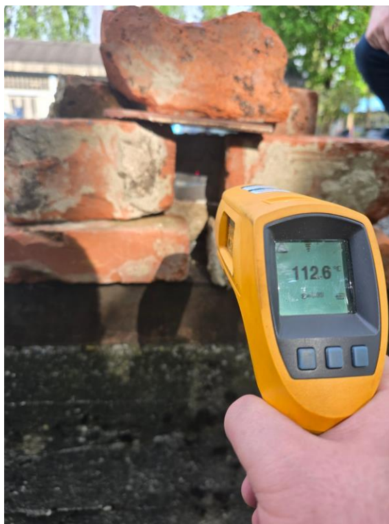
Slika 87 Mjerenje temperature uzorka sa stražnje strane ispitne pločice
