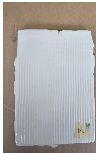
Slika 66 Pločica B2 nakon vlažne komore
