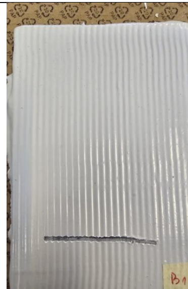
Slika 52 Uzorak B1 prije slane komore
