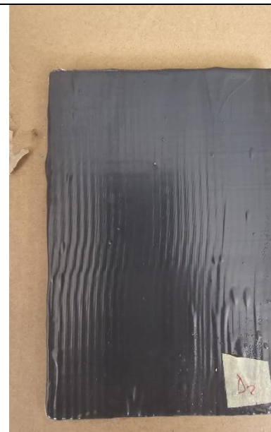
Slika 63 Pločica D2 nakon vlažne komore
