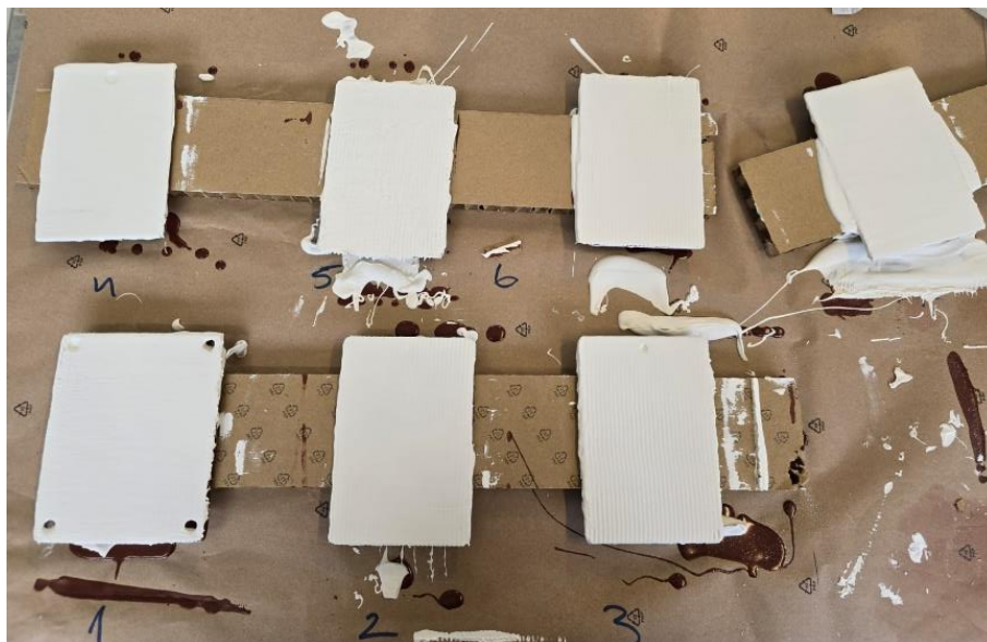
Slika 29 Helios protupožarni premaz uzorci
