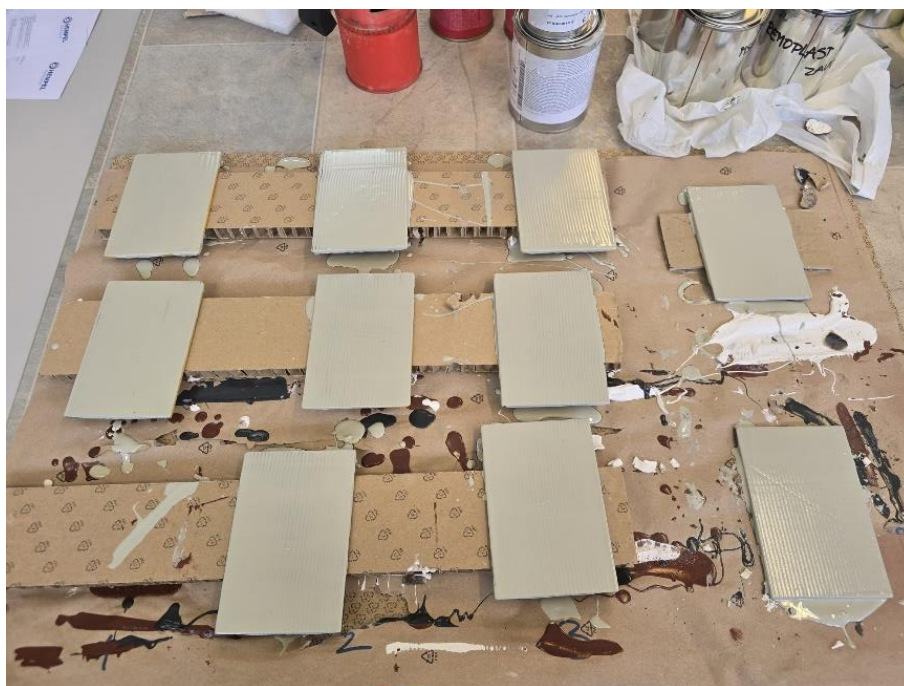
Slika 25 Sušenje Hempel temeljnog premaza
