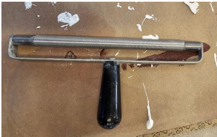
Slika 35 Spiralni aplikator od 100 µm
