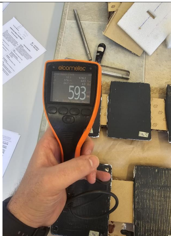
Slika 43 Mjerenje pomoću uređaja Elcometer 456
