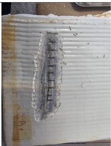
Slika 57 Pločica B1 nakon slane komore
