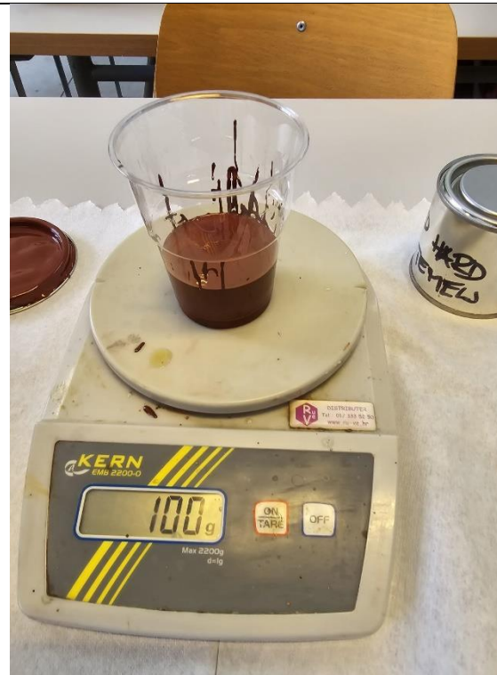
Slika 19 Miješanje Helios komponenti
