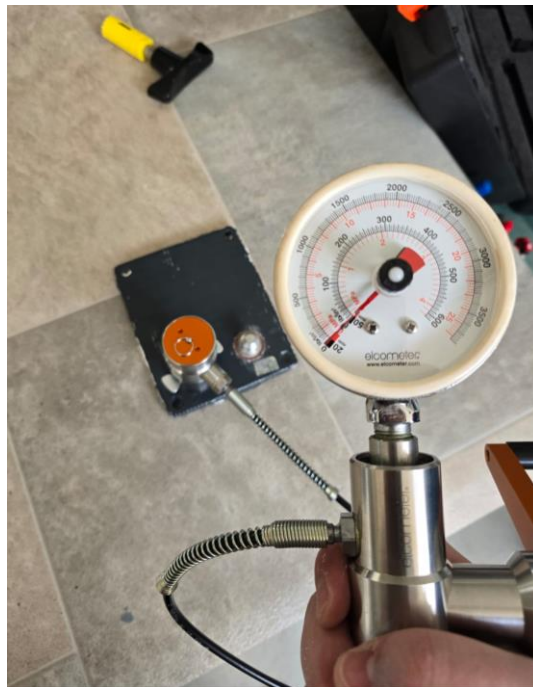
Slika 80 Pull-off uređaj Elcometer 406
