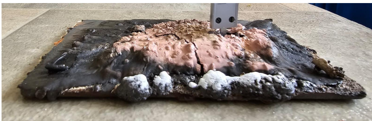
Slika 89 Mjerenje debljine pjene na H5 uzorku pomoću pomične mjerke
