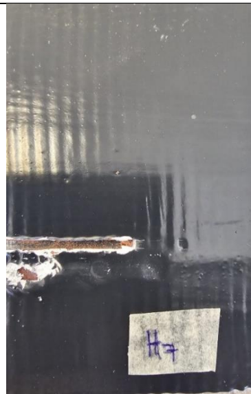
Slika 48 Uzorak H7 prije slane komore
