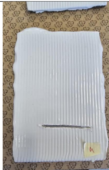
Slika 51 Uzorak 4 prije slane komore
