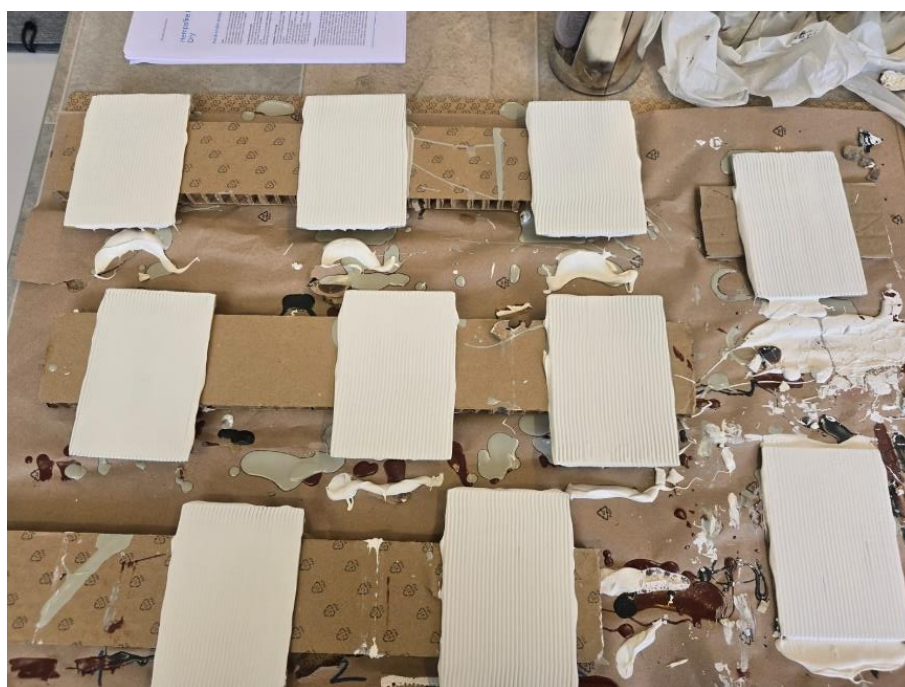
Slika 30 Hempel protupožarni premaz uzorci
