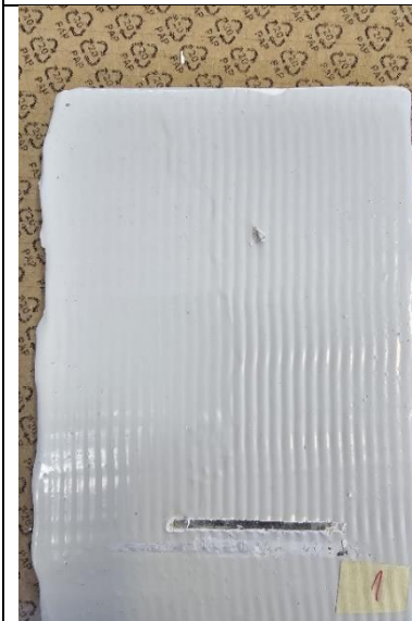
Slika 50 Uzorak 1 prije slane komore
