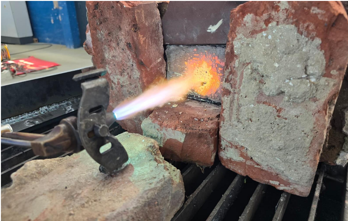
Slika 91 Paljenje uzorka H4 plamenikom za plinsko zavarivanje
