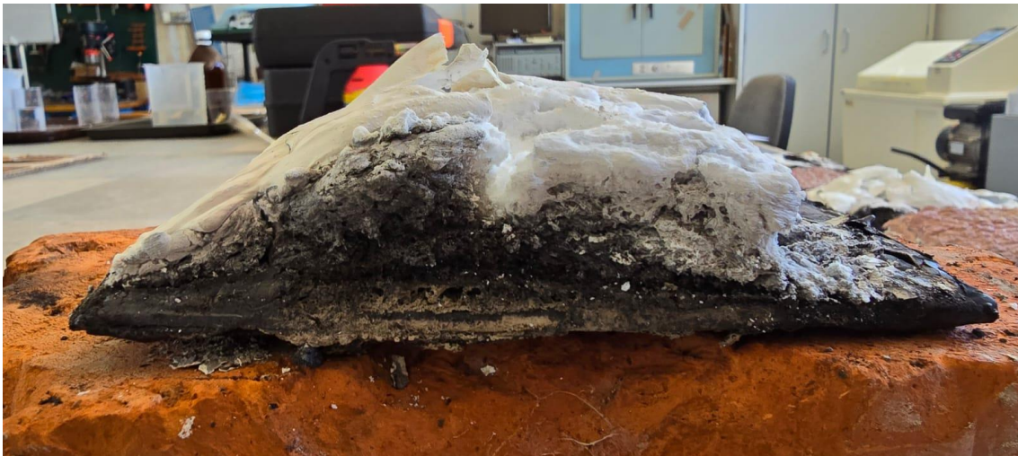
Slika 92 Mjerenje pjene na ispitnom uzorku 2
