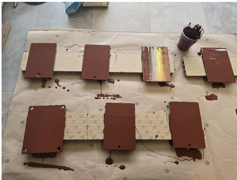
Slika 24 Sušenje Helios temeljnog premaza
