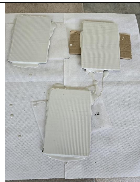
Slika 41 Sustav premaza HEM30
