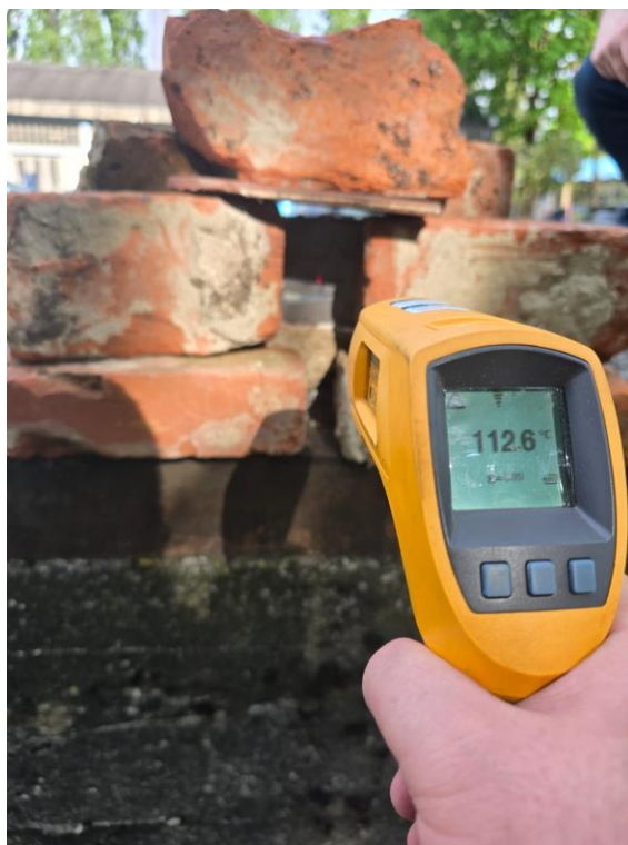
Slika 87 Mjerenje temperature uzoraka sa stražnje strane ispitne pločice
