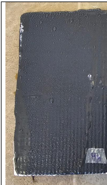
Slika 61 Pločica H4 nakon vlažne komore
