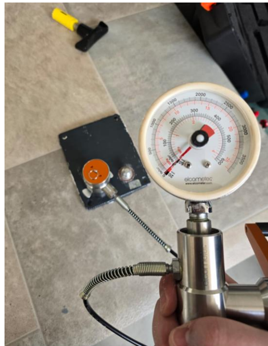
Slika 80 Pull-off uređaj Elcometer 406
