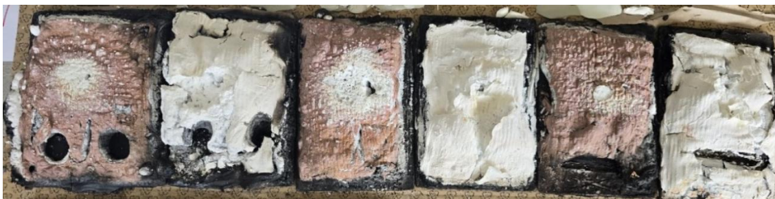
Slika 93 Pločice H1;H2;H4 i 2;4;5 nakon paljenja
