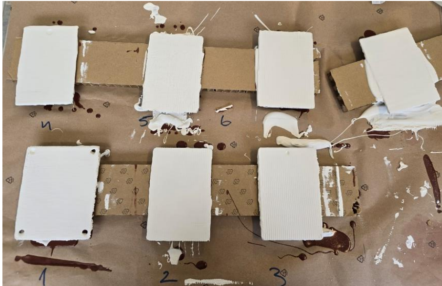
Slika 29 Helios protupožarni premaz uzorci
