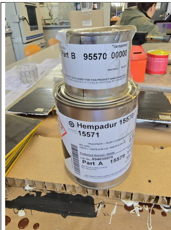
Slika 20 Komponente Hempel temelja
