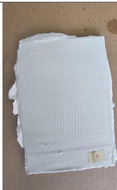
Slika 65 Pločica 7 nakon vlažne komore
