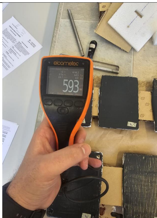
Slika 43 Mjerenje pomoću uređaja Elcometer 456
