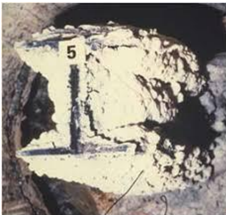
Slika 8 Formirana termoizolacijska pjena nakon požara.
