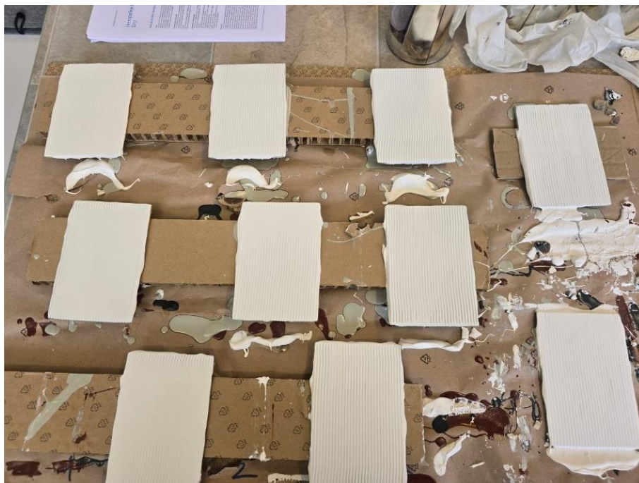
Slika 30 Hempel protupožarni premaz uzorci
