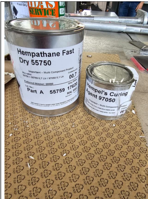
Slika 33 Komponente Hempel završnog premaza
