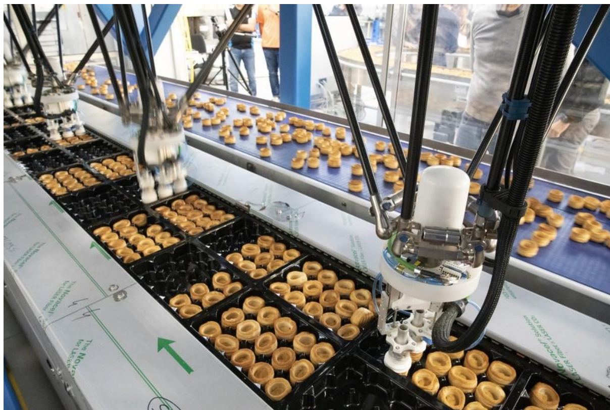
Slika 2929 Delta roboti u prehrambenoj industriji [38]
