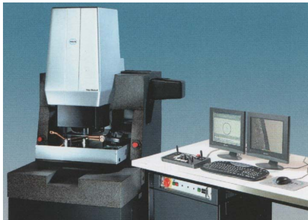
Slika 27. Uređaj mostnog tipa sa pomičnim stolom i fiksnim mostom
