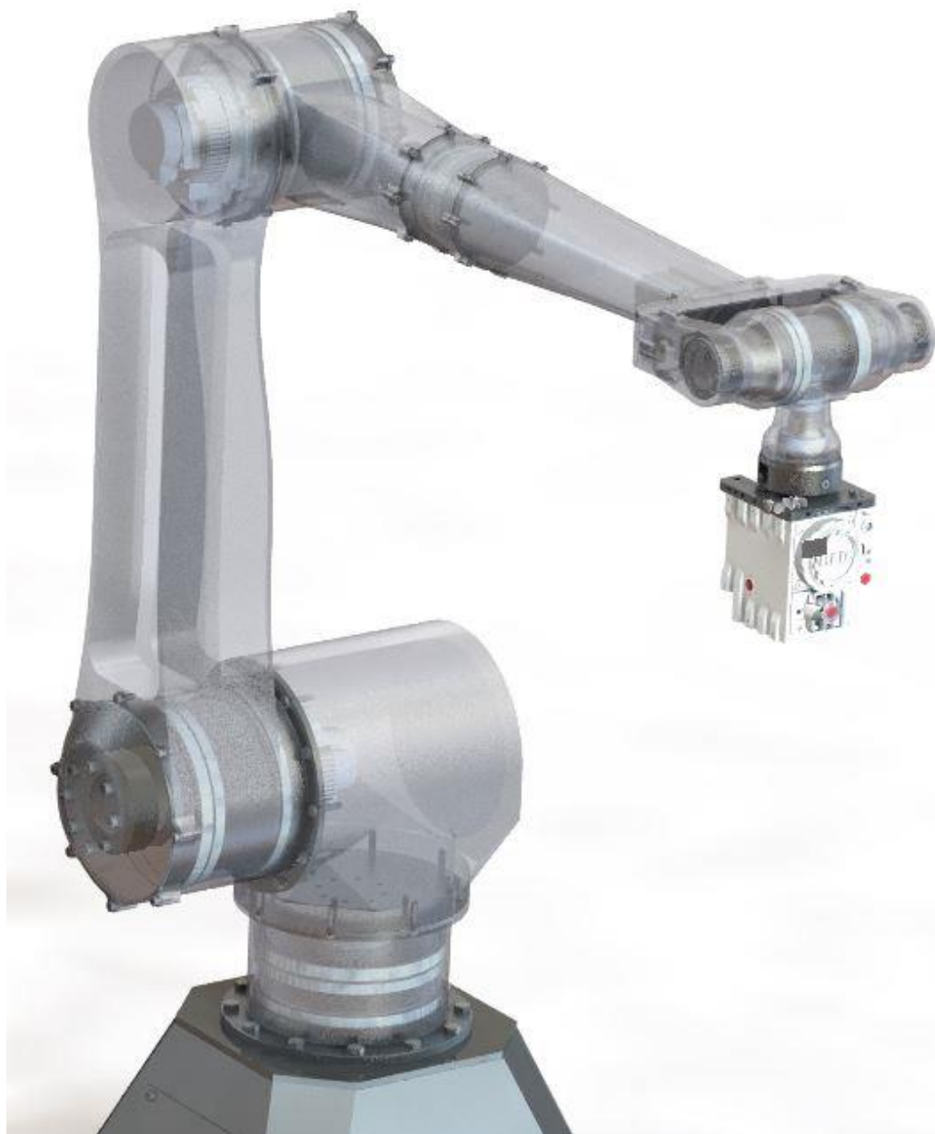
Slika 88. Robotska ruka s prikazanim pogonima u zglobovima
