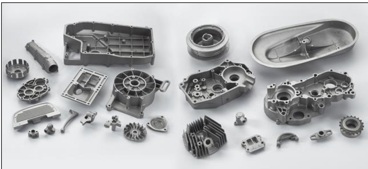
Slika 3 Dijelovi motora automobila dobivenim tlačnim lijevanjem [4]
