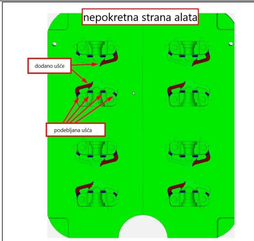
Slika 54 Promjena konstrukcije alata (nepokretna strana)
