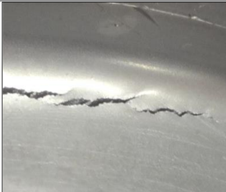
Slika 27 Topla pukotina na odljevku
