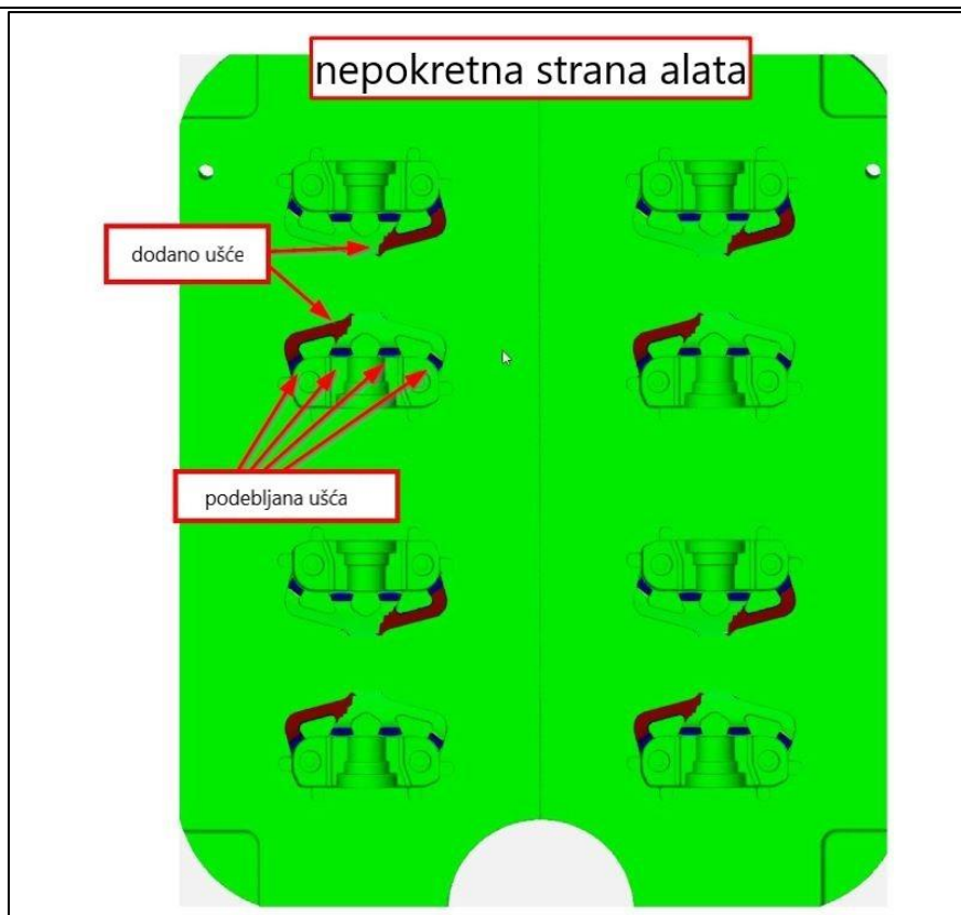
Slika 54 Promjena konstrukcije alata (nepokretna strana)
