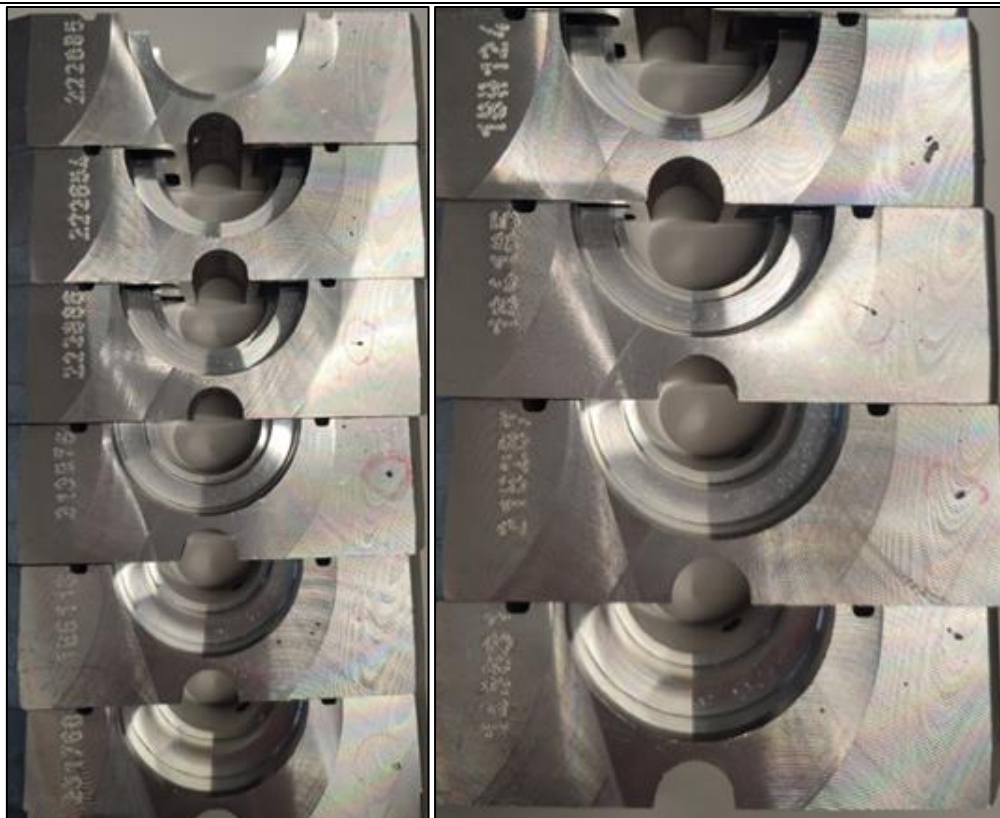
Slika 43 Poroznost na komadima pozicije 624.15 nakon obrade
