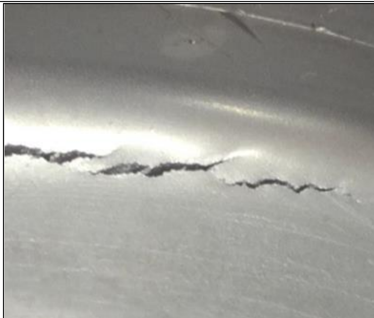
Slika 27 Topla pukotina na odljevku
