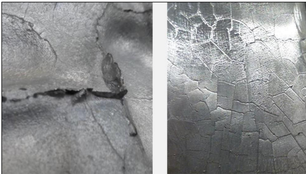
Slika 26 Pukotine na kalupu
