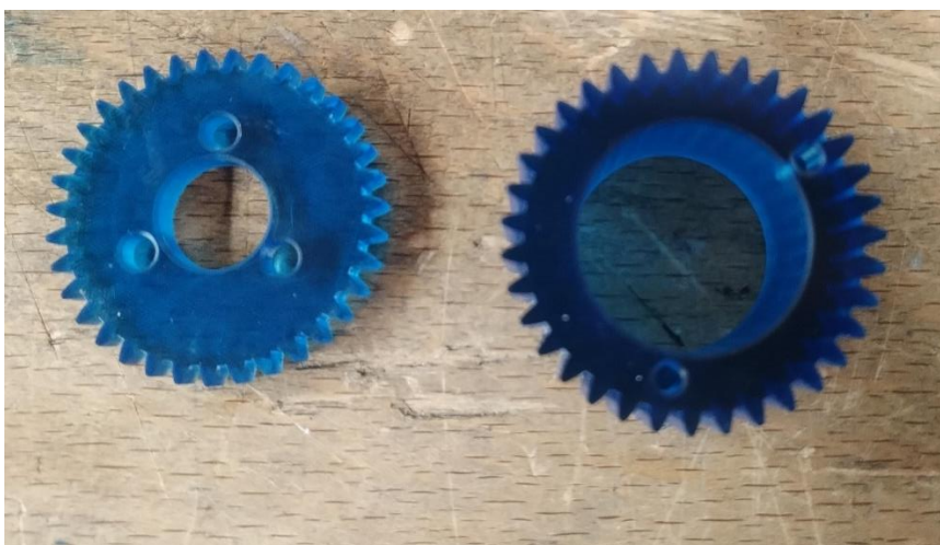
Slika 54 Zupčanci izrađeni korištenjem SLA tehnologije
