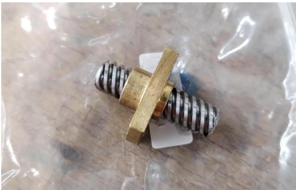
Slika 53 Korištena matica i vreteno
