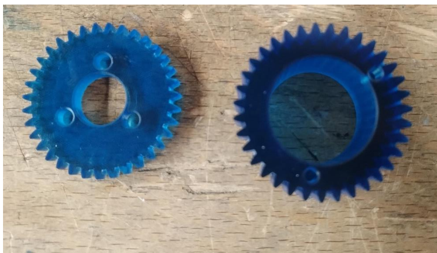
Slika 54 Zupčanci izrađeni korištenjem SLA tehnologije
