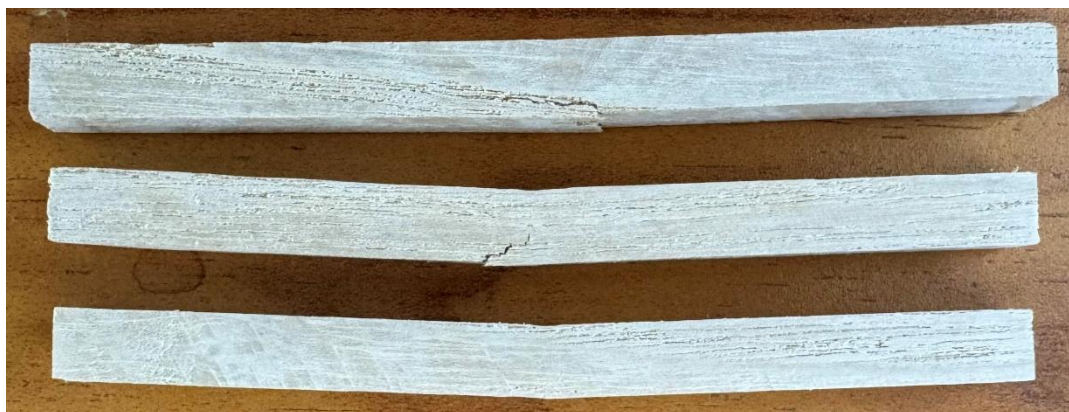
Slika 36. Primjeri ispitanih uzoraka nakon loma
