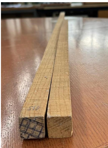
Slika 31. Subfosilno drvo jasena za ispitivanje
