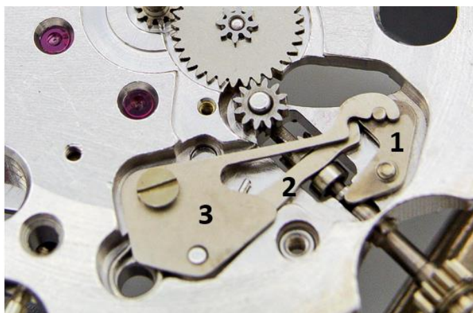
Slika 20. Mehanizam namještanja kazaljki [16]
