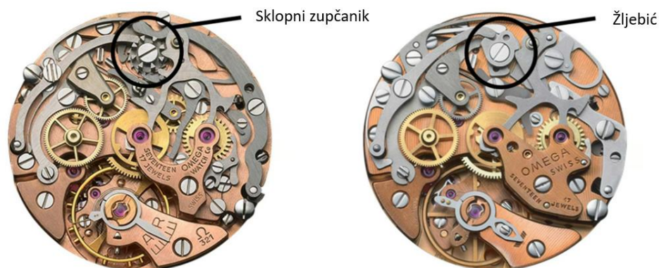
Slika 34. Mehanizam sa sklopnim zupčanikom i žljebićem [21]
