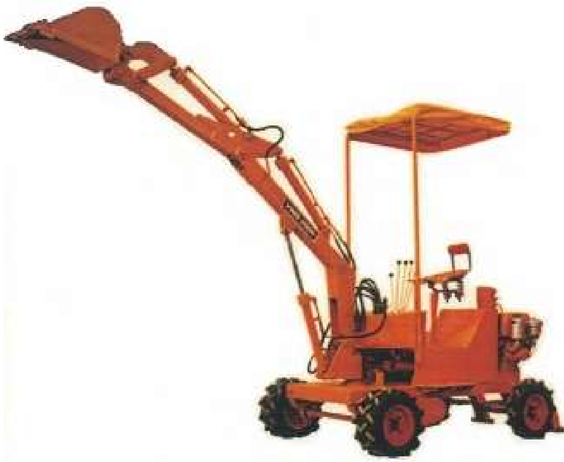
Slika 7. Yanmar YNB300 , prvi mini bager s vlastitim pogonom [13]
