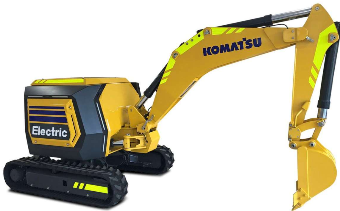
Slika 10. Koncept električnog, daljinski upravljanih mini bagera tvrtke Komatsu [17]
