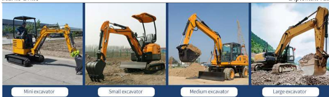
Slika 3. Podjela bagera prema veličini, s lijeva na desno: mini, midi, srednji i veliki [6]
