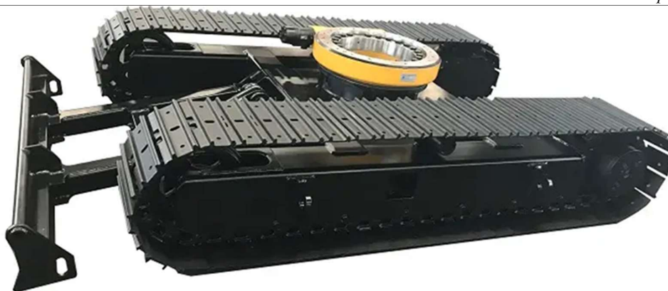
Slika 13. Izvedba podvozja mini bagera s dozerskim nožem [21]
