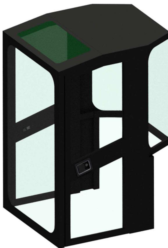
Slika 39. 3D CAD model zatvorene kabine mini bagera
