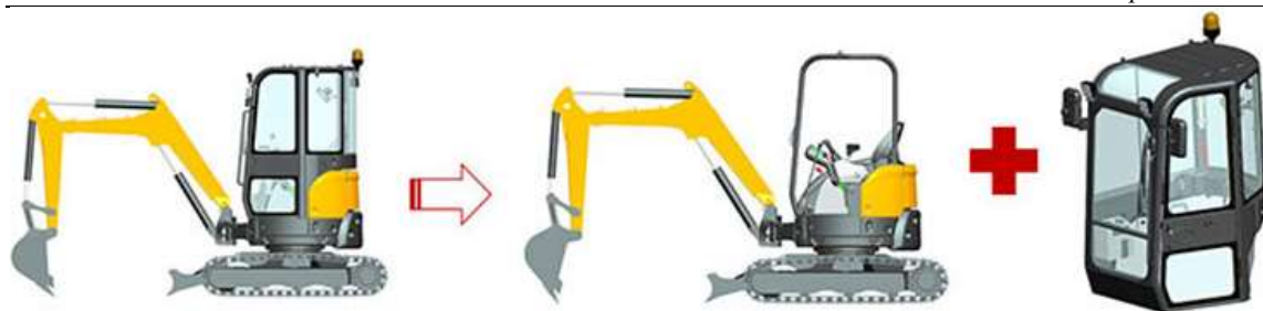
Slika 15. Modularna izvedba za odabir izgleda prostora operatera [22]
