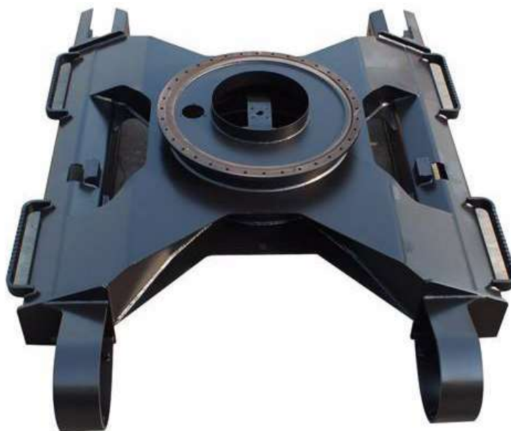
Slika 14. X okvir, „šasisija“ mini bagera [20]
