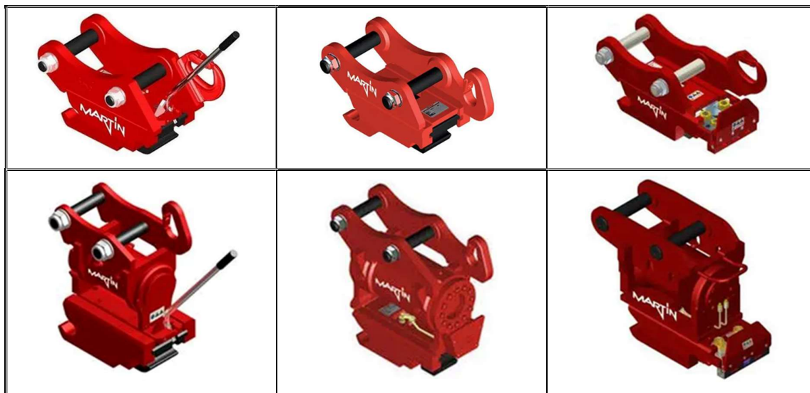
Tablica 2. Brze spojke; bez dodatnog zakreta(gore): mehanička (lijevo), hidraulička (sredina), hidraulička s automatskim spajanjem hidrauličkih vodova (desno); s bočnim nagibom-Powertilt (dolje): s mehaničkim otpuštanjem (lijevo), s hidrauličkim (sredina), s hidrauličkim uz automatsko spajanje hidrauličkih vodova (desno)
