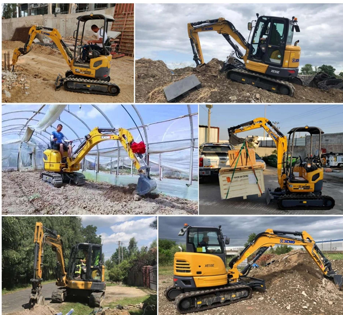
Slika 11. Primjeri poslova koje obavlja mini bager [18]
