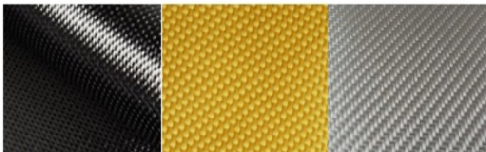
Slika 5. Ugljična, aramidna i staklena vlakna [7]
