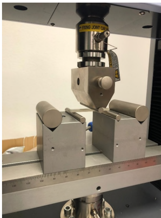
Slika 33. Postavljeni ispitni uzorak na stroju za savojno ispitivanje
