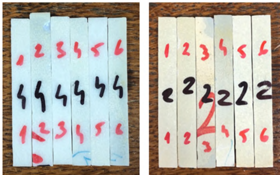
Slika 39. Izrezani ispitni uzorci s metalnim nanočesticama \text{TiO}_2 – 1 wt% (lijevo) i 2 wt% (desno)
