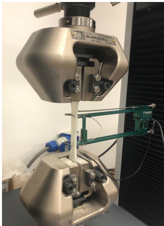
Slika 26. Pravilno postavljen ispitni uzorak u prihvatnoj glavi čeljusti kidalice
