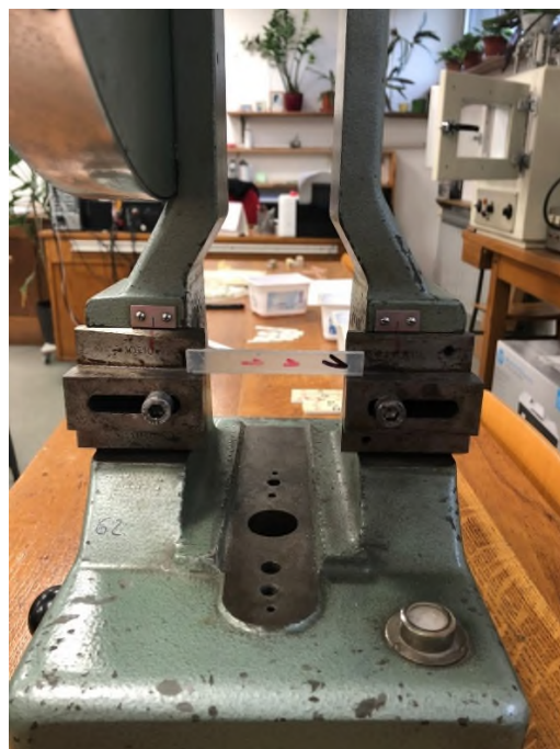
Slika 41. Horizontalni položaj ispitnog uzorna na Charpy-jevom batu
