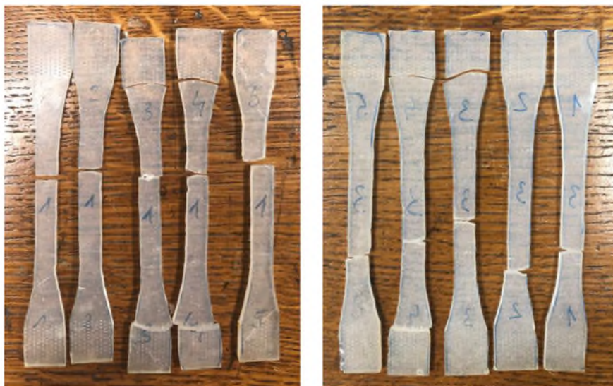
Slika 27. Ispitni uzorci nakon provedenog statičkog – vlačnog pokusa, SiO 2 – 1 wt% (lijevo) i 2 wt% (desno)
