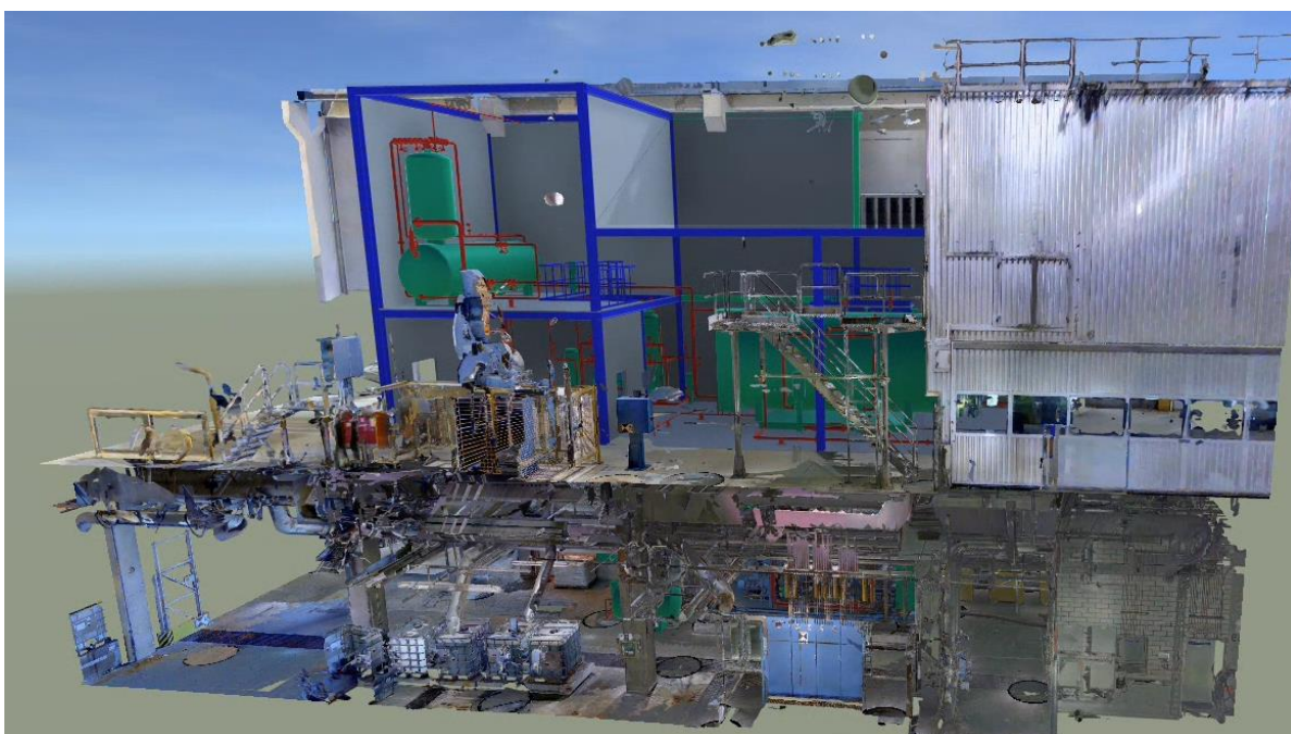
Slika 22. Model stvoren softverom UPV s integriranim laserskim skenom
