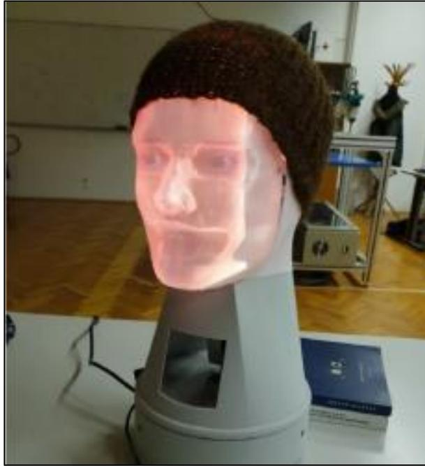
Slika 11 Prototip afektivne humanoidne robotske glave PLEA [26]
