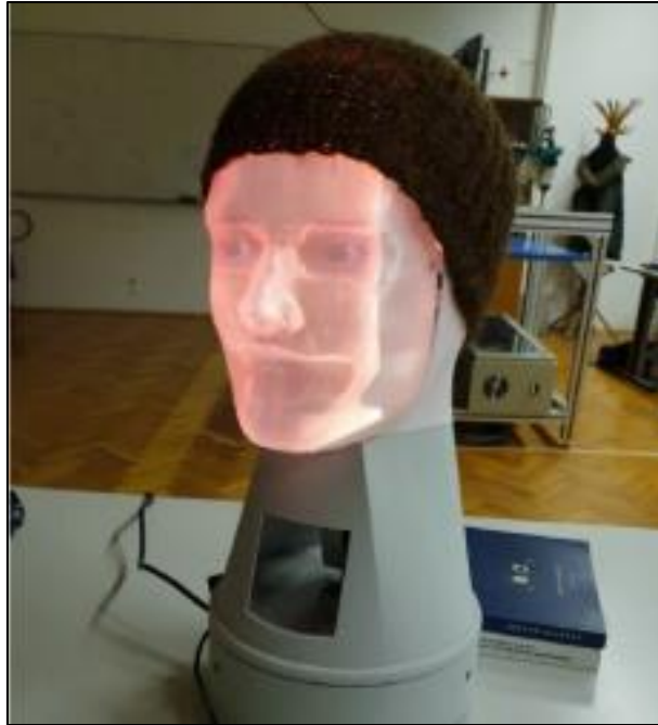
Slika 11 Prototip afektivne humanoidne robotske glave PLEA [26]
