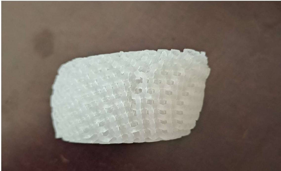
Slika 34. Loptica 1 nakon ispitivanja pritisnih svojstava na kidalici
