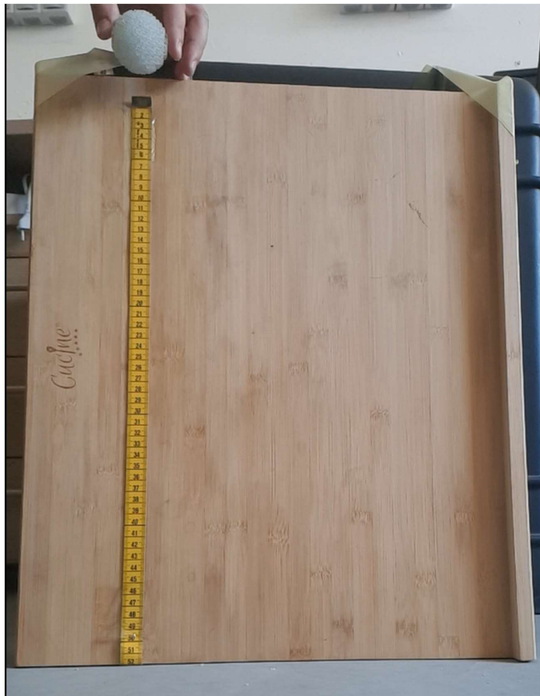
Slika 28. Ispitivanje elastičnosti loptice odbijanjem od podloge
