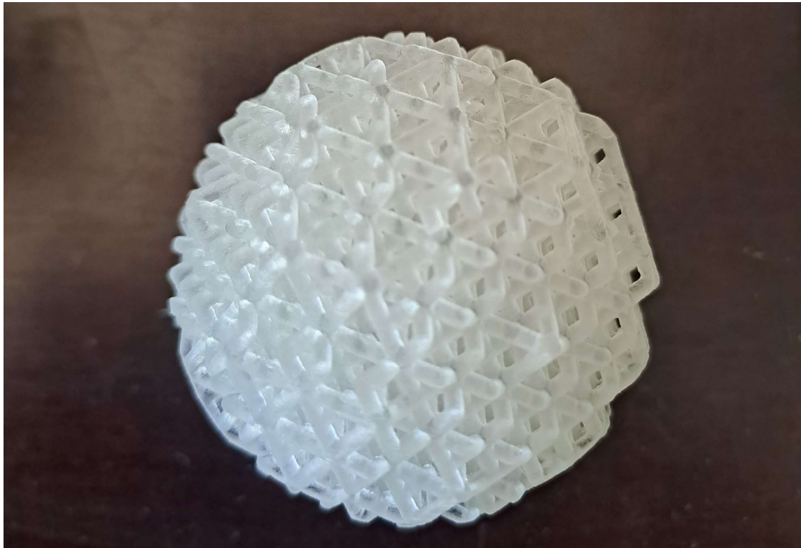
Slika 27. Loptica 3 nakon uklanjanja suportne strukture
