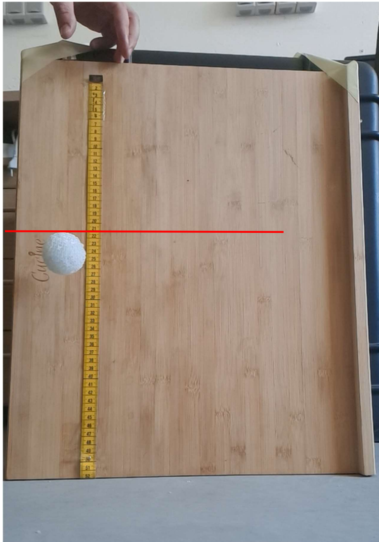
Slika 30. Loptica 2 - ispitivanje elastičnosti odbijanjem od podloge
