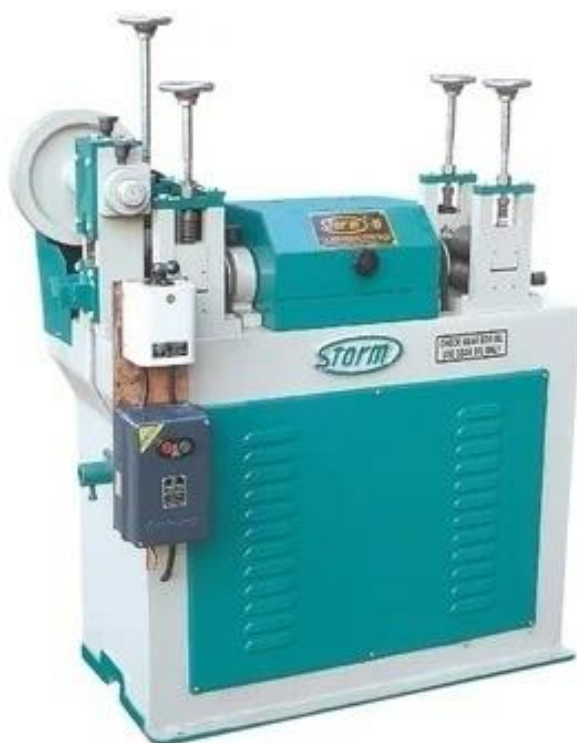
Slika 15. Double Roller uređaj za izravnanje i rezanje žice [13]
