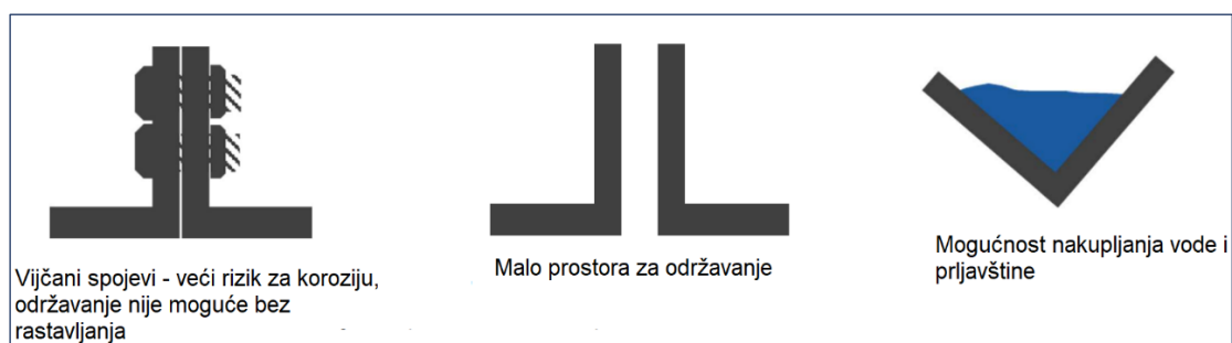
Slika 40. Konstrukcijska rješenja koja treba izbjegavati [39]
