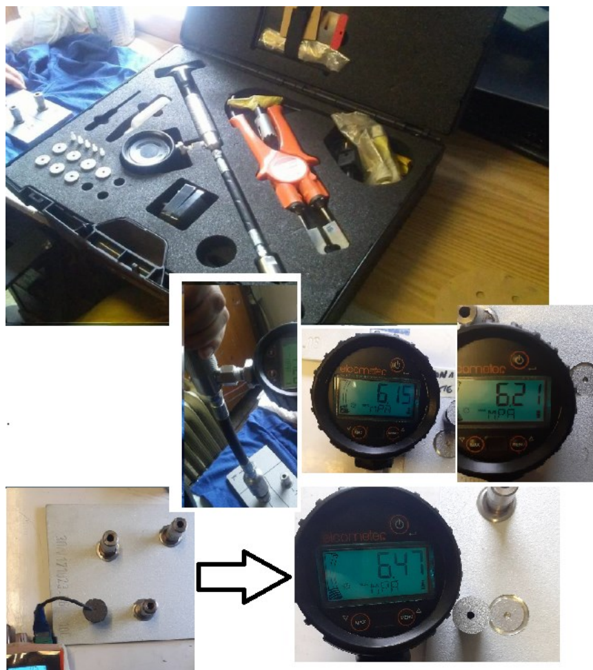
Slika 47. Pull off test
