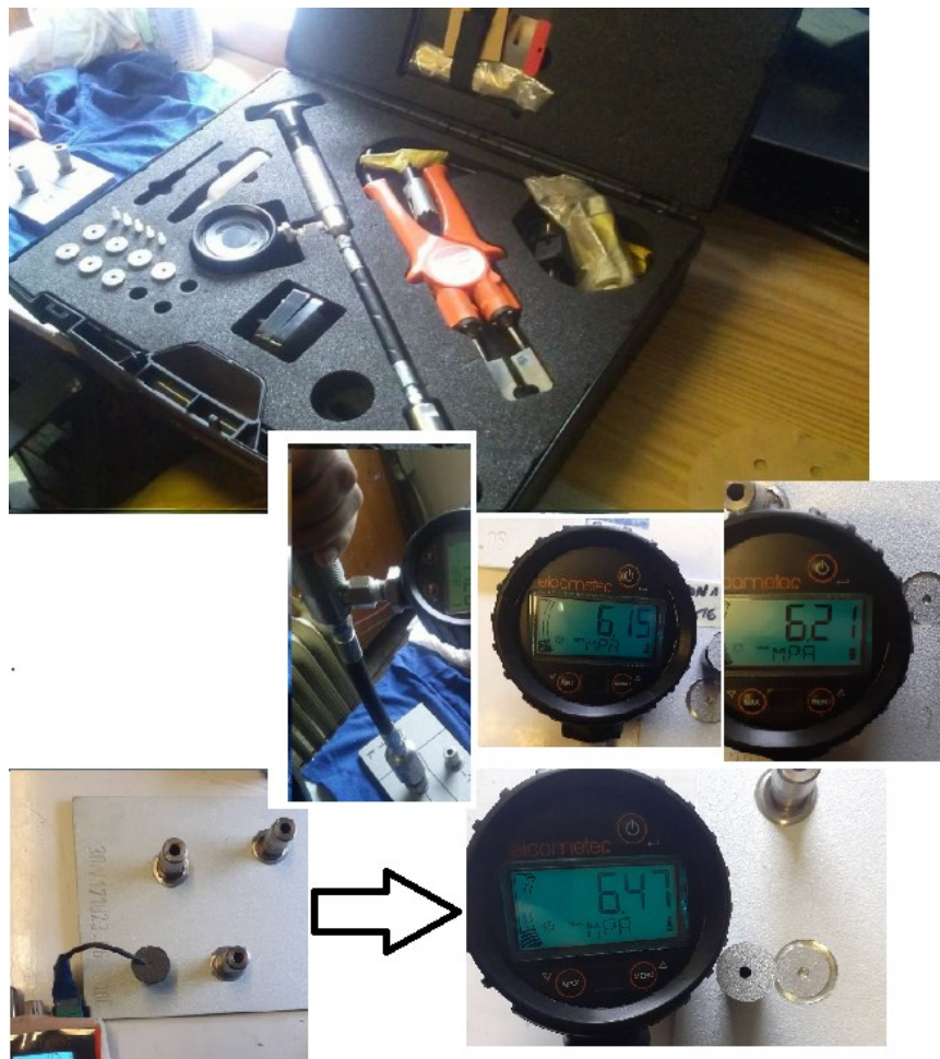
Slika 47. Pull off test
