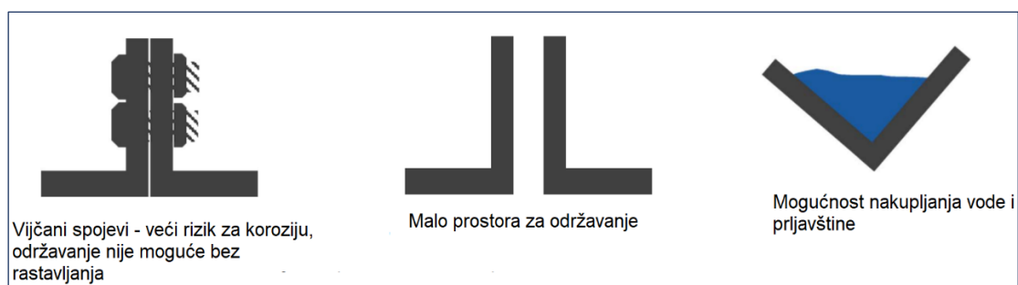
Slika 40. Konstrukcijska rješenja koja treba izbjegavati [39]
