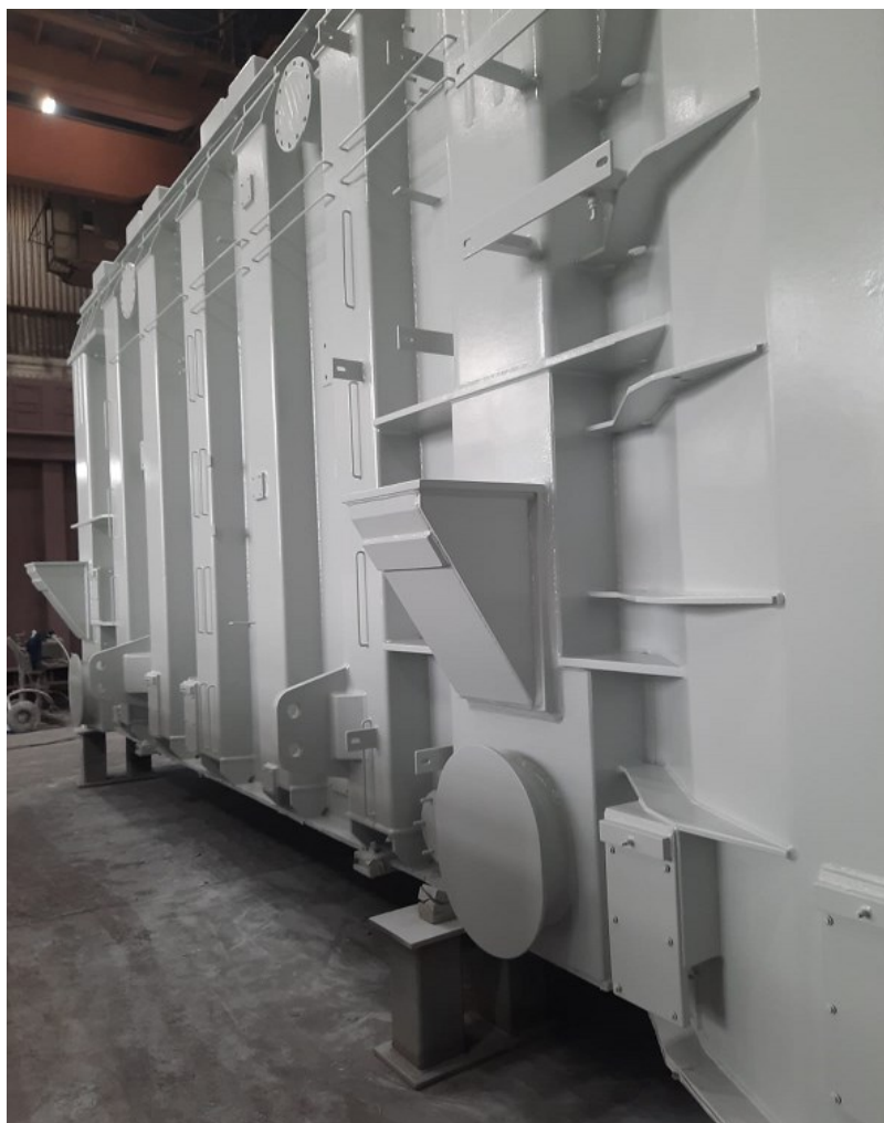
Slika 38. Transformatorski kotao u fazi sušenja premaza
