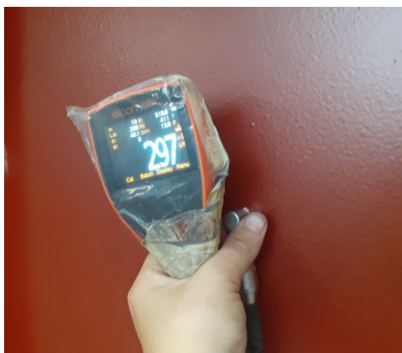
Slika 46. Izmjera debljine boje
