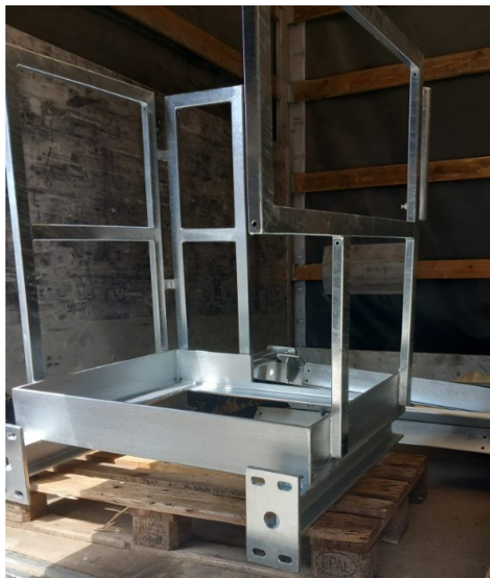
Slika 20. Podest zaštićen vrućim uranjanjem
