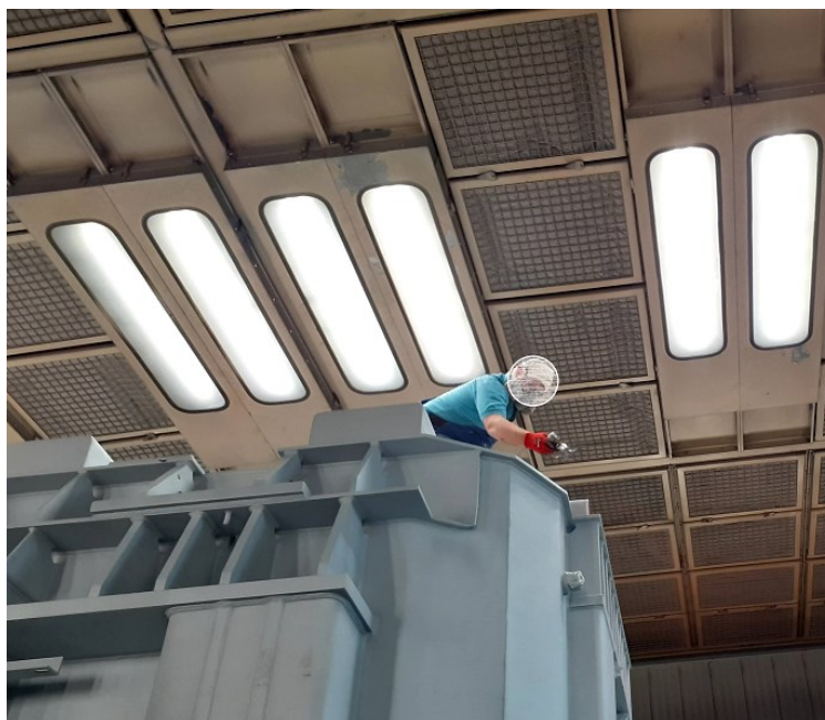
Slika 35. Ispuhivanje zaostale sačme komprimiranim zrakom
