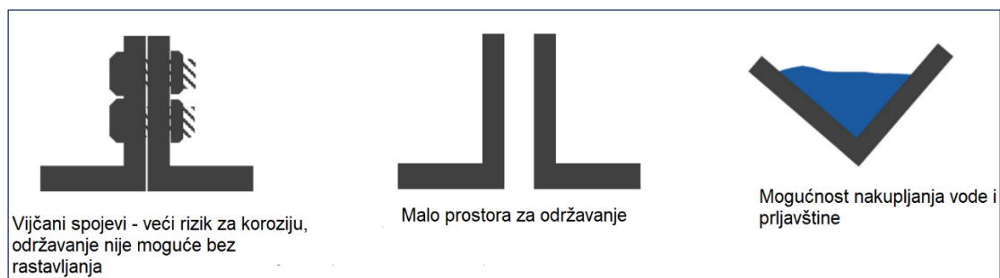
Slika 40. Konstrukcijska rješenja koja treba izbjegavati [39]
