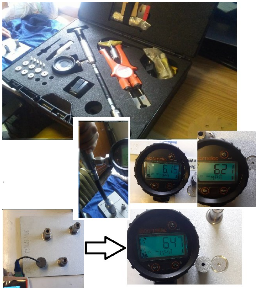
Slika 47. Pull off test
