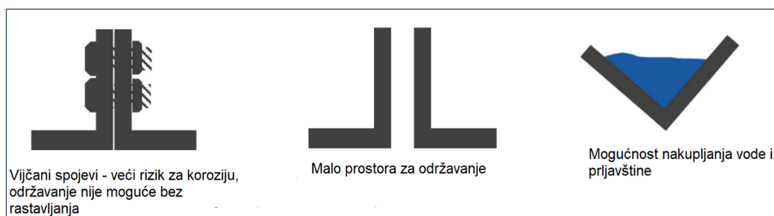
Slika 40. Konstrukcijska rješenja koja treba izbjegavati [39]
