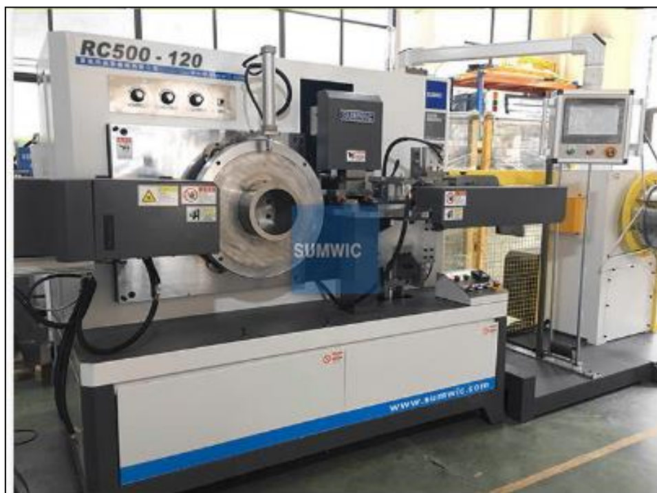
Slika 6. Prikaz dijela za namatanje [1]
