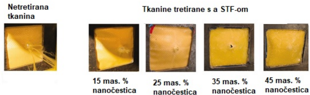
Slika 11. Morfologija Kevlar® tkanine nakon balističkih testova [58].
