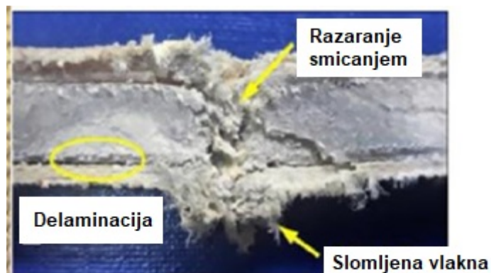
Slika 10. Prikaz poprečnog presjeka kompozita oštećenih uslijed balističkog udara [57]
