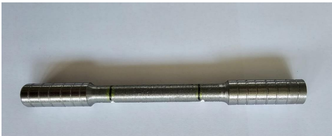
Slika 14. Označen ispitni uzorak sa grubom površinom
