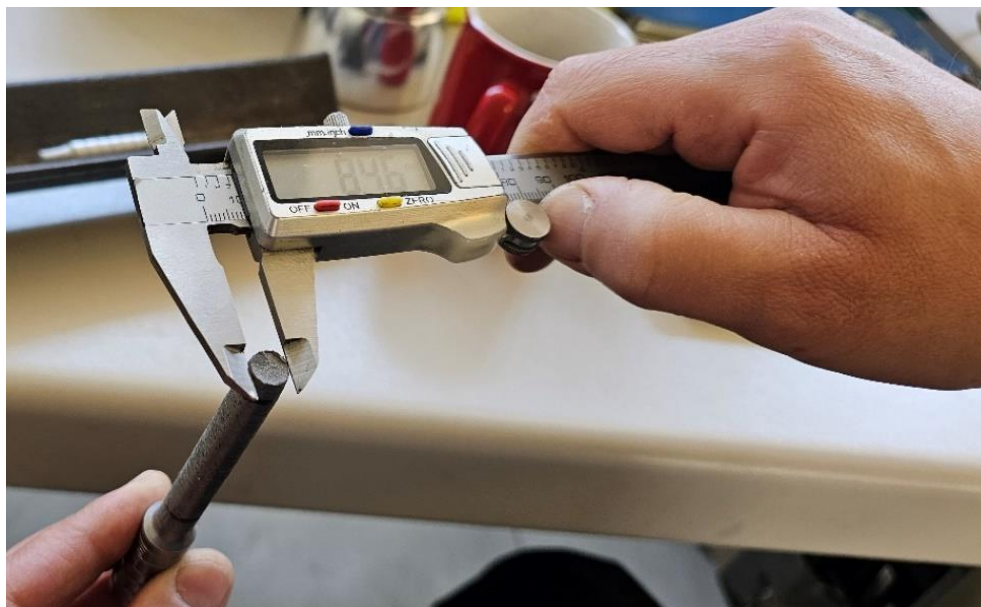
Slika 21. Mjerenje konačnog promjera d_u
