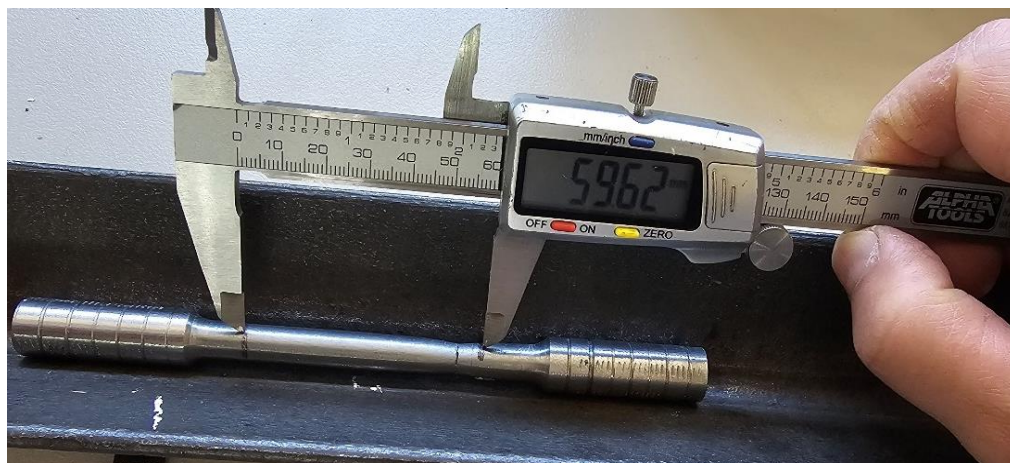
Slika 20. Mjerenje produljenja nakon loma L_u
