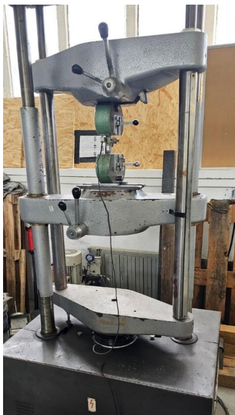
Slika 16. Kidalica WPM Leipzig EU 40 mod
